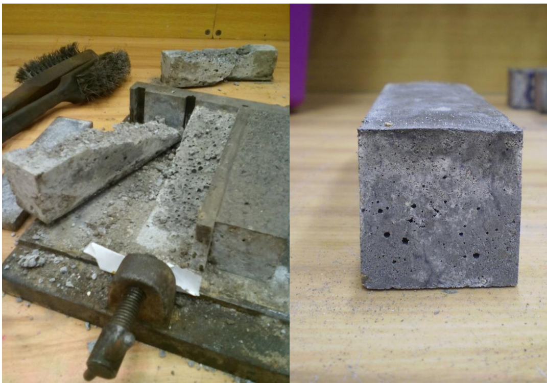
Obrázek 27: Vlevo – rozpad zkušebních těles receptury E po odformování, vpravo – zkušební těleso receptury C po odformování
