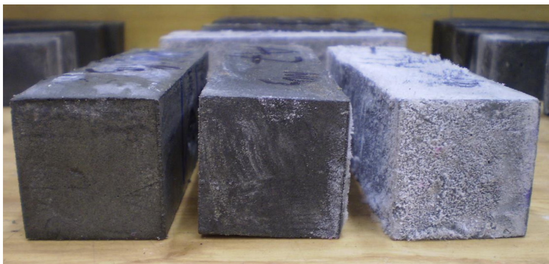
Obrázek 48: Tělesa receptury A po vyjmutí z agresivního prostředí po 56 dnech a oschnutí (vlevo \text{Mg}^{2+} , uprostřed \text{NO}_3^- , vpravo \text{SO}_4^{2-} )
