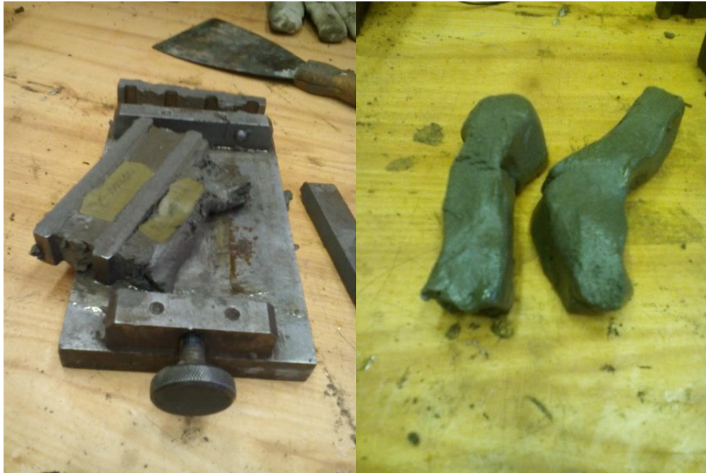
Obrázek 23: Zkušební tělesa po 5 dnech zrání v otevřené atmosféře při 20 °C
