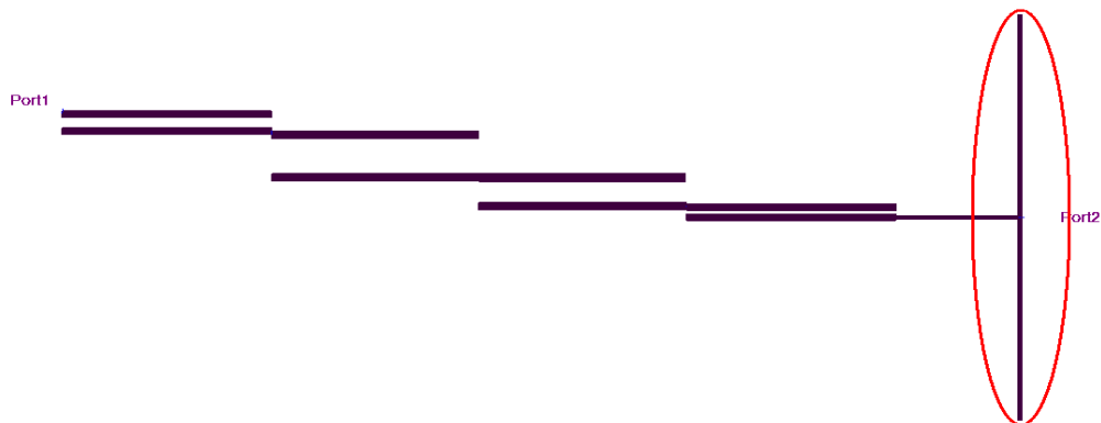
Obr. 25. Topologie paralelně vázaného mikropáskového filtru rozšířeného o dva pahýly blokující centrální kmitočet
