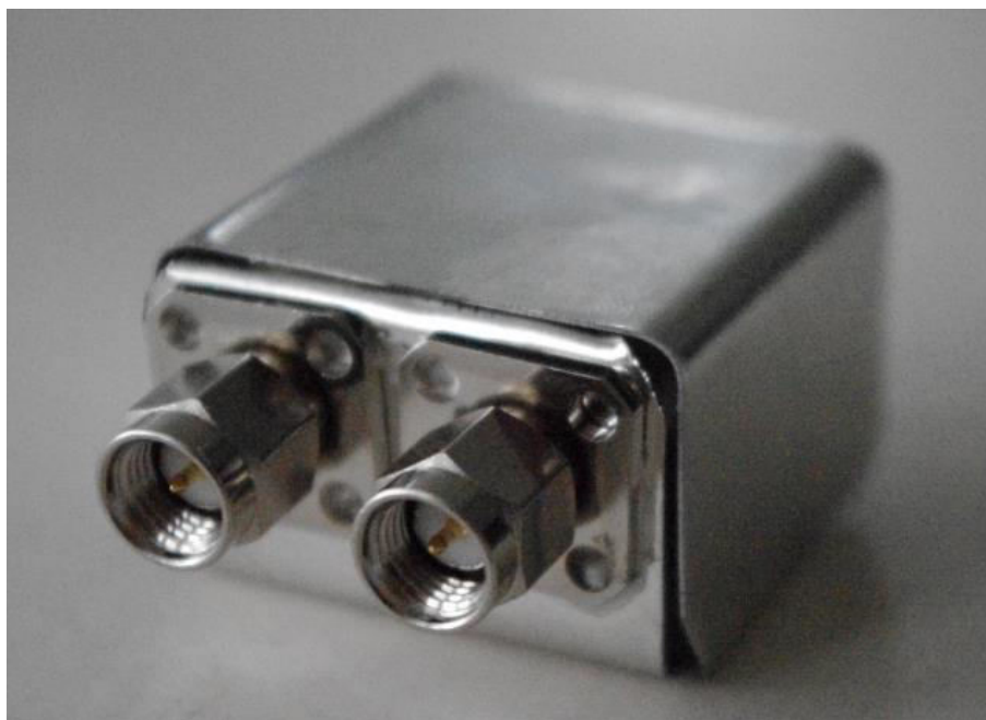
Obr. 5. Kovový box sloužící jako pouzdro pro HIO
