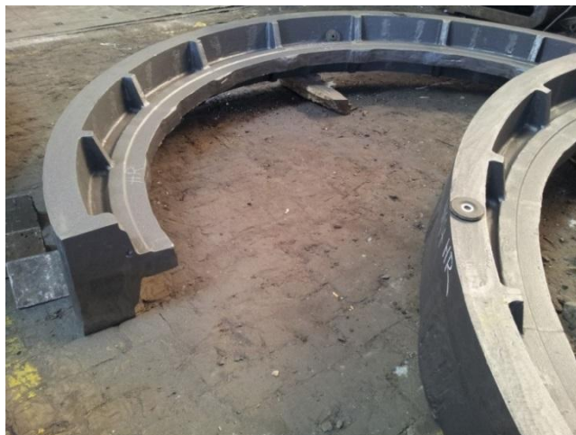
Obr. 2.6 Půl věnec po odstranění nálitků.
