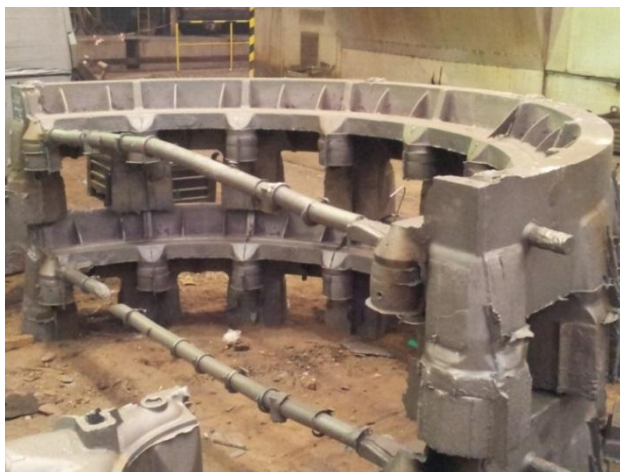
Obr. 2.5 Očištěné půl věnce od písku s nálitky.
