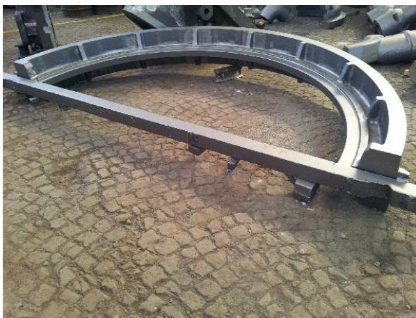
Obr. 2.9 Zafixování průměru poloviny ozubeného věnce.
