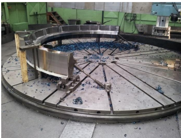
Obr. 2.7 Hrubování půl věnce na svislém CNC soustruhu SKJ 50-100.
