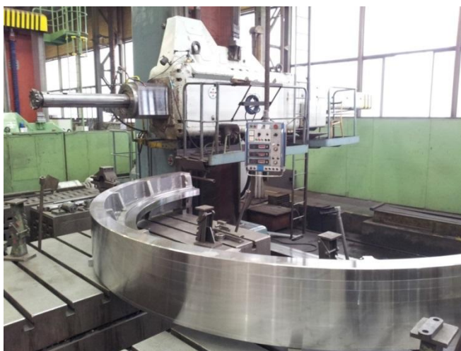
Obr. 2.8 Opracování dělicí roviny na vodorovné vyvrtávačce WD 200/6000.
