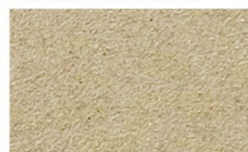
Obr. 64 – Vzorčky hliněné omítky CEMIX s kaseinem po vystavení povětrnostním vlivům (archiv autora)
