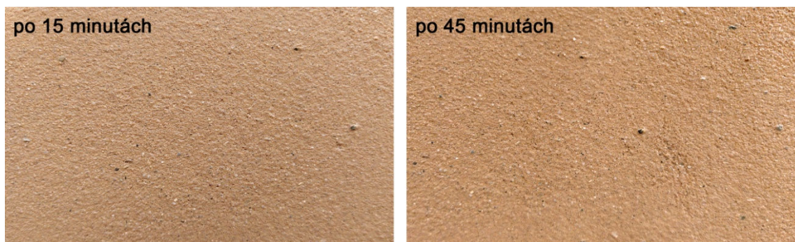
Obr. 47 - Vzorky hliněné omítky PICAS s 0,5 % ricinového oleje po vystavení zkoušce postřikem (archiv autora)
