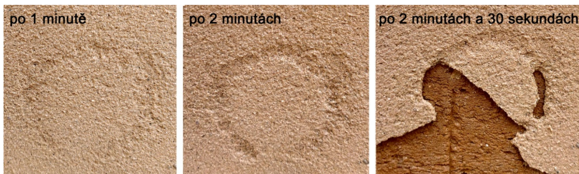
Obr. 46 – Vzorčky hliněné omítky CEMIX referenční po vystavení zkoušce postřikem (archiv autora)
