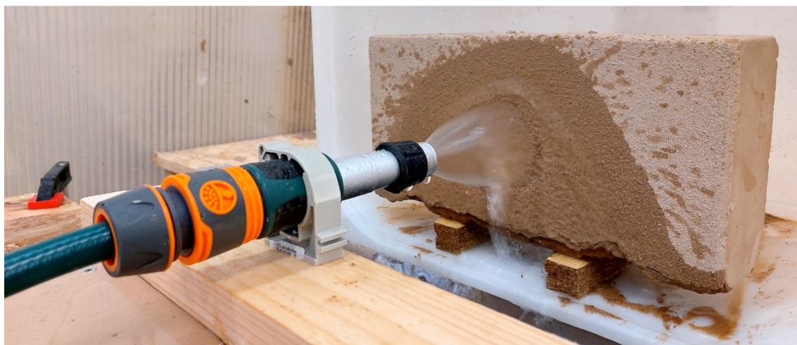
Obr. 25 – Měření odolnosti proti dešťové erozi – zkouška postřikem (archiv autora)
