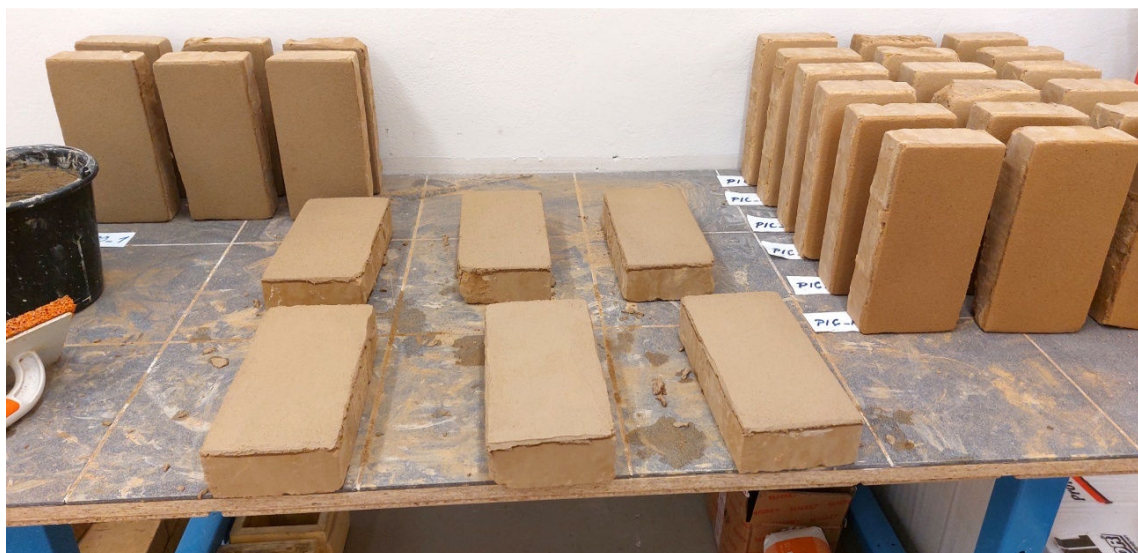
Obr. 23 – Výroba zkušebních vzorků pro měření odolnosti proti dešťové erozi zkouškou postřikem (archiv autora)
