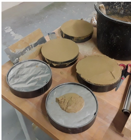
Obr. 26 – Výroba zkušebních vzorků pro měření difuze vodní páry: nalévání čerstvé směsi do forem (archiv autora)
