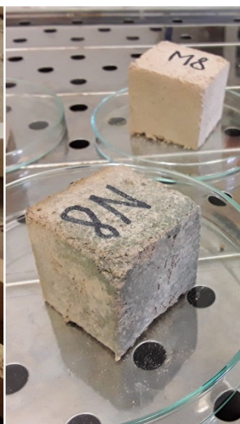
Obr. 16 – Plíseň, která vznikla po vystavení vzorků se 4 % kaseinu extrémním vlhkostním podmínkám v klimatické komoře (archiv autora)
