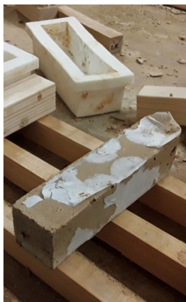
Obr. 15 – Bílý povlak, který vznikl při vysychání zkušebních trámečků s 8 % kaseinu (archiv autora)
