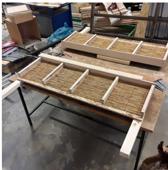
Obr. 30 – Výroba panelů pro zkoušení odolnosti proti povětrnostním vlivům: výroba dřevěné konstrukce a aplikace rákosové rohože (archiv autora)
