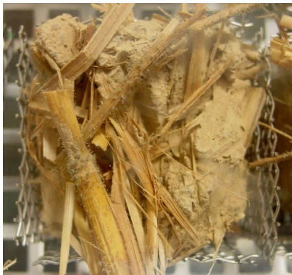
Obr. 34 – Slámohlinitý kompozit, který byl naočkován suspenzí spor hub a následně vystaven zátěžovým podmínkám v inkubační komoře (teplota 25°C, relativní vlhkost 95 %, 100 dní) (Danielewicz, 2008).
