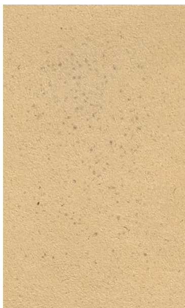
Obr. 14 – Šedé tečky, které vznikly na povrchu vzorku se 4 % ricinového oleje po dlouhodobém vystavení povětrnostním vlivům – stav po 15 měsících (archiv autora)
