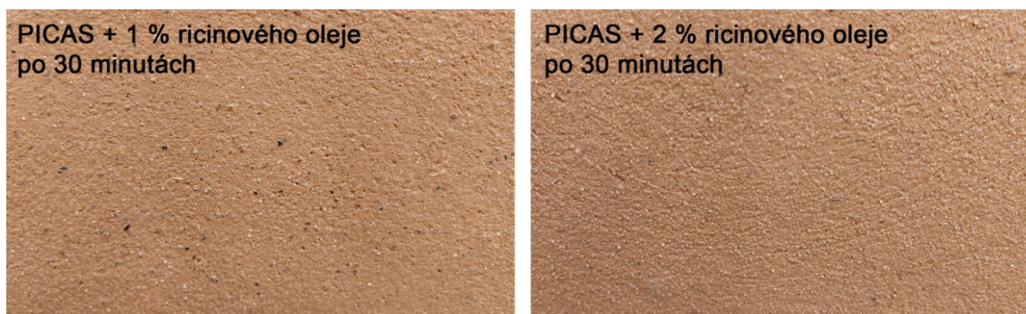
Obr. 49 – Vzorky hliněné omítky PICAS s 1 % a se 2 % ricinového oleje po vystavení zkoušce postříkem (archiv autora)
