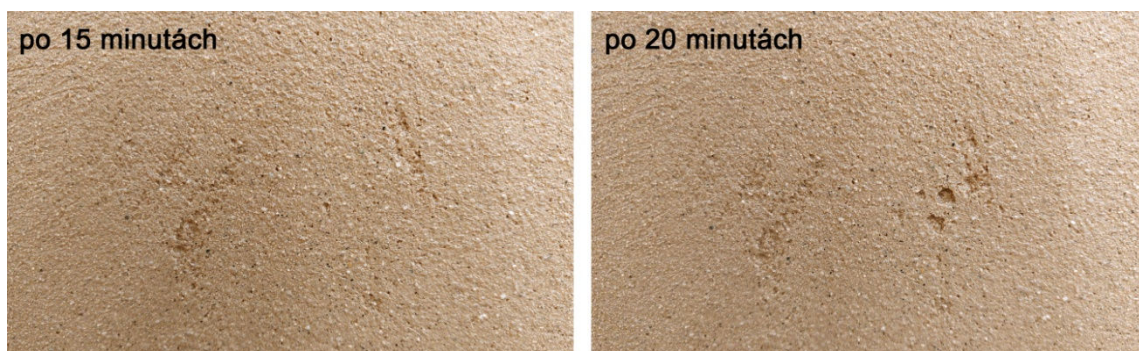
Obr. 48 – Vzorky hliněné omítky CEMIX s 0,5 % ricinového oleje po vystavení zkoušce postřikem (archiv autora)
