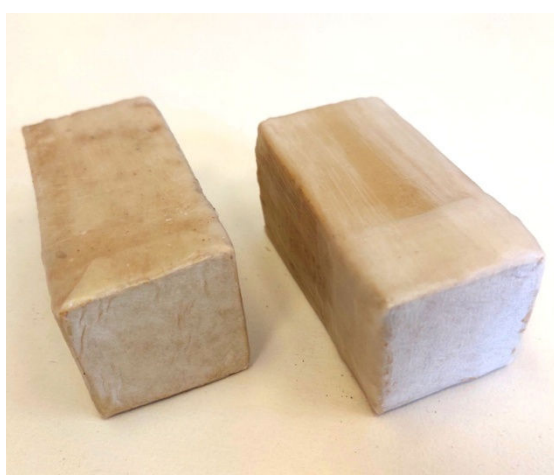
Obr. 21 – Upevnění filtračního papíru na spodní straně zkušebního trámečku pomocí vosku pro účely zkoušky kapilární absorpce vody (archiv autora)
