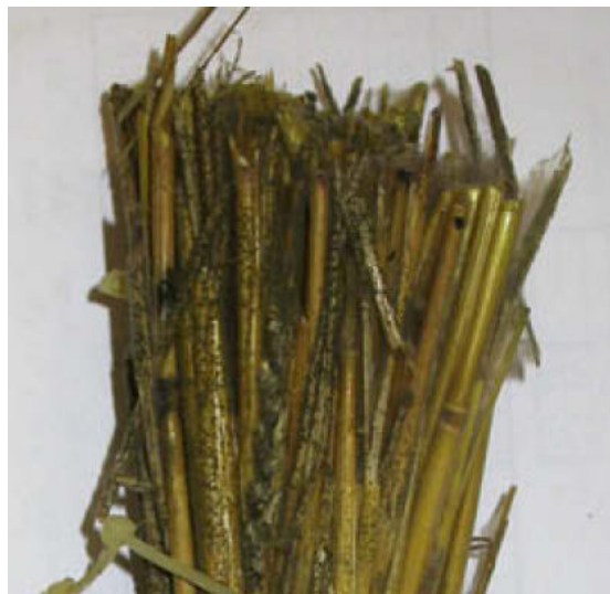
Obr. 35 – Vzorek pšeničné slámy vystavený vlhkosti 98 % po dobu, než došlo k jeho nasycení – objemové zvětšení, počínající hniloba a vytvoření plísně na povrchu (Lawrence, 2009)
