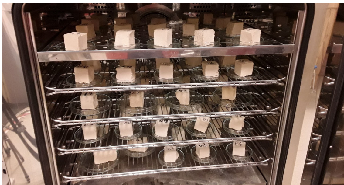
Obr. 29 – Měření hygroskopické sorpce v klimatické komoře (archiv autora)
