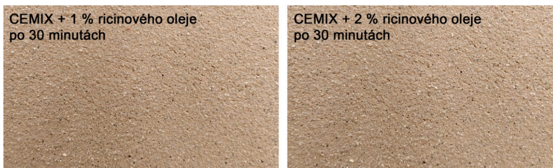
Obr. 50 – Vzorky hliněné omítky CEMIX s 1 % a se 2 % ricinového oleje po vystavení zkoušce postříkem (archiv autora)
