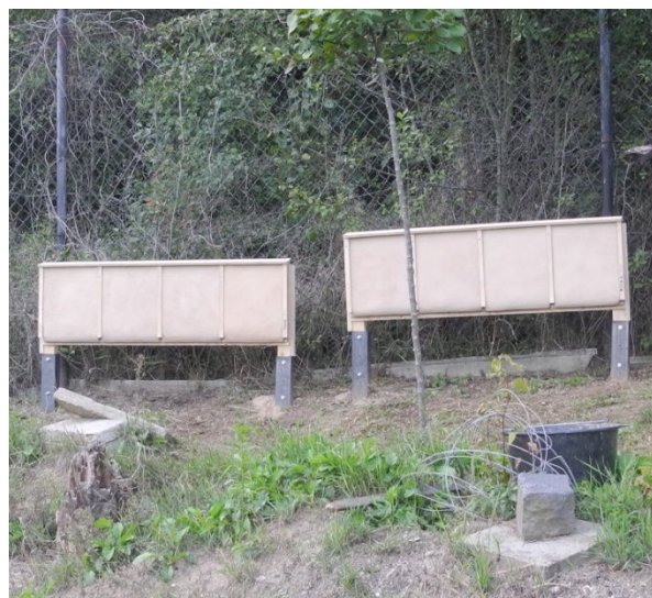
Obr. 31 – Osazení zkušebních panelů s hliněnými omítkami na pozemek v Brně – Kníničkách pro měření odolnosti proti povětrnostním vlivům (archiv autora)
