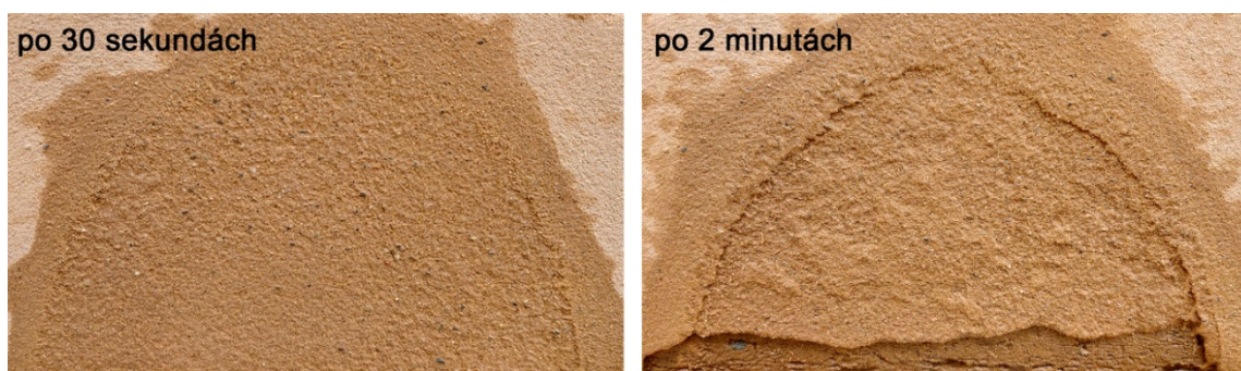
Obr. 45 – Vzorčky hliněné omítky PICAS referenční po vystavení zkoušce postřikem (archiv autora)
