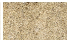
Obr. 64 – Vzorčky hliněné omítky CEMIX s kaseinem po vystavení povětrnostním vlivům (archiv autora)
