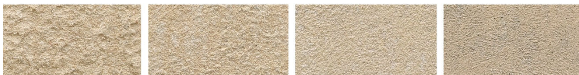
Obr. 61 – Vzorky hliněné omítky PICAS s ricinovým olejem po vystavení povětrnostním vlivům (archiv autora)
