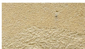
Obr. 64 – Vzorčky hliněné omítky CEMIX s kaseinem po vystavení povětrnostním vlivům (archiv autora)
