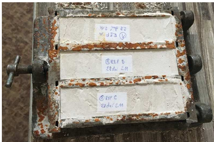
Obrázek 14: Agresivní působení referenčního vzorku na ocelovou formu
