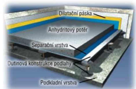
Obrázek 9: Skladba potěru pro dutinové podlahy [33]
