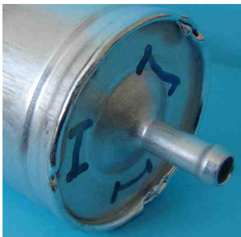
Obr. 7.15 Vzorek č. 2, deformace víčka od kořene spojovaných dílů.
