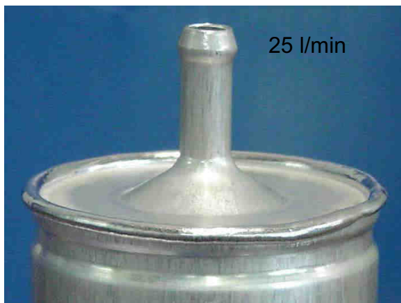
Obr. 7.17 Tvary svaru při různých průtocích plynu.
