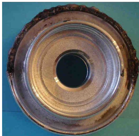
Obr. 7.24 Následek znečištěných ploch na kvalitu svaru.
