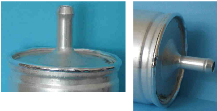
Obr. 7.21 Výsledek nastavení balančního regulátoru na hodnotu +5.
