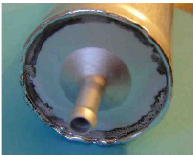
Obr. 7.32 Znehodnocení svaru z důvodu nedodržení postupu čištění filtru.
