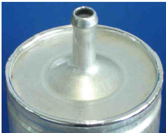
Obr. 7.13 Vzorek č.1, deformace víčka.
