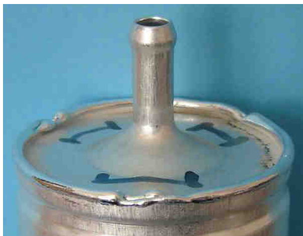
Obr. 7.15 Vzorek č. 2, deformace víčka od kořene spojovaných dílů.
