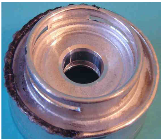
Obr. 7.24 Následek znečištěných ploch na kvalitu svaru.
