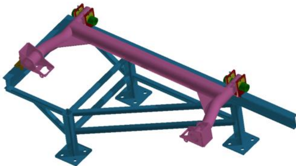
Obr. 40 Model měřícího stavu s upevněnou nápravnicí
