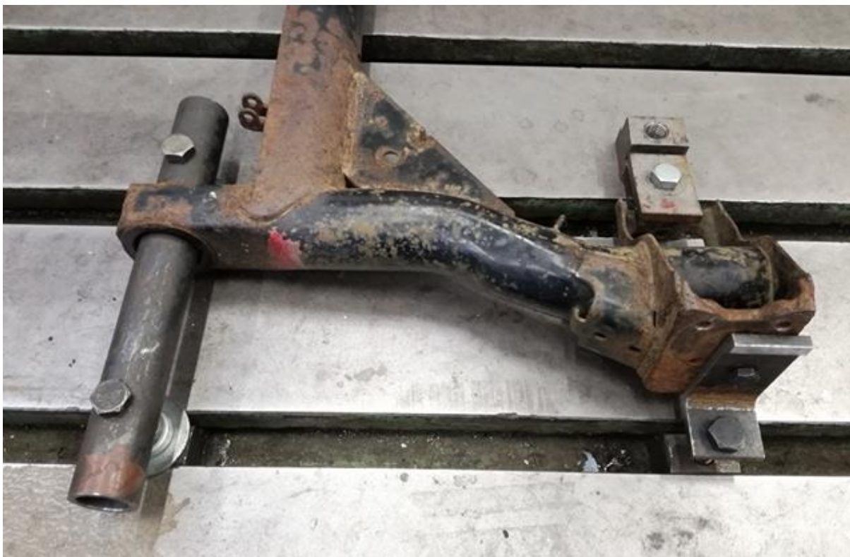
Obr. 26 Uchycení podélného ramene pomocí připravených součástí
