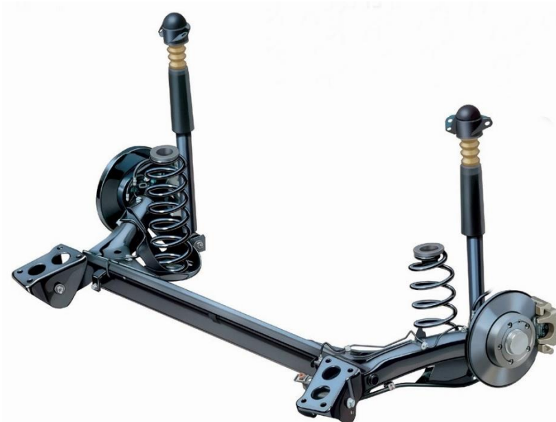
Obr. 4 Konstrukce nápravy s torzní příčkou [4]
