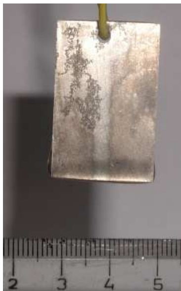
Obrázek 10 - Vzorek AZ31 po 8 hodinové expozici v 3% NaCl
