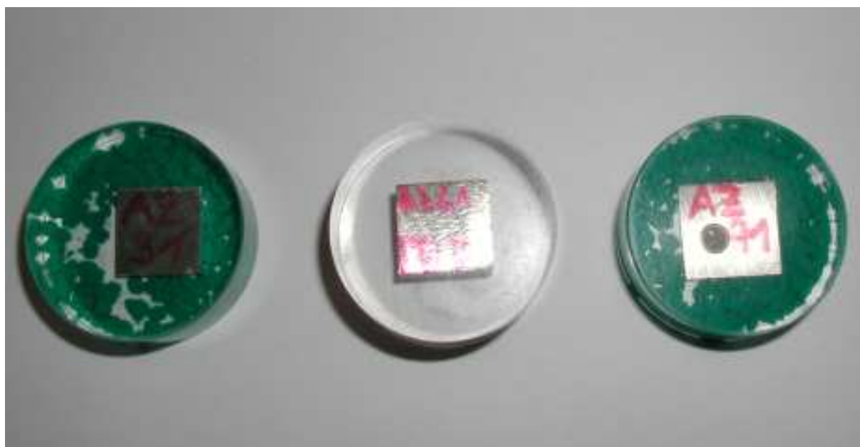
Obrázek 9 - Zalisované vzorky jednotlivých slitin
