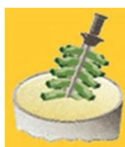
Namáčení do keramické břečky
