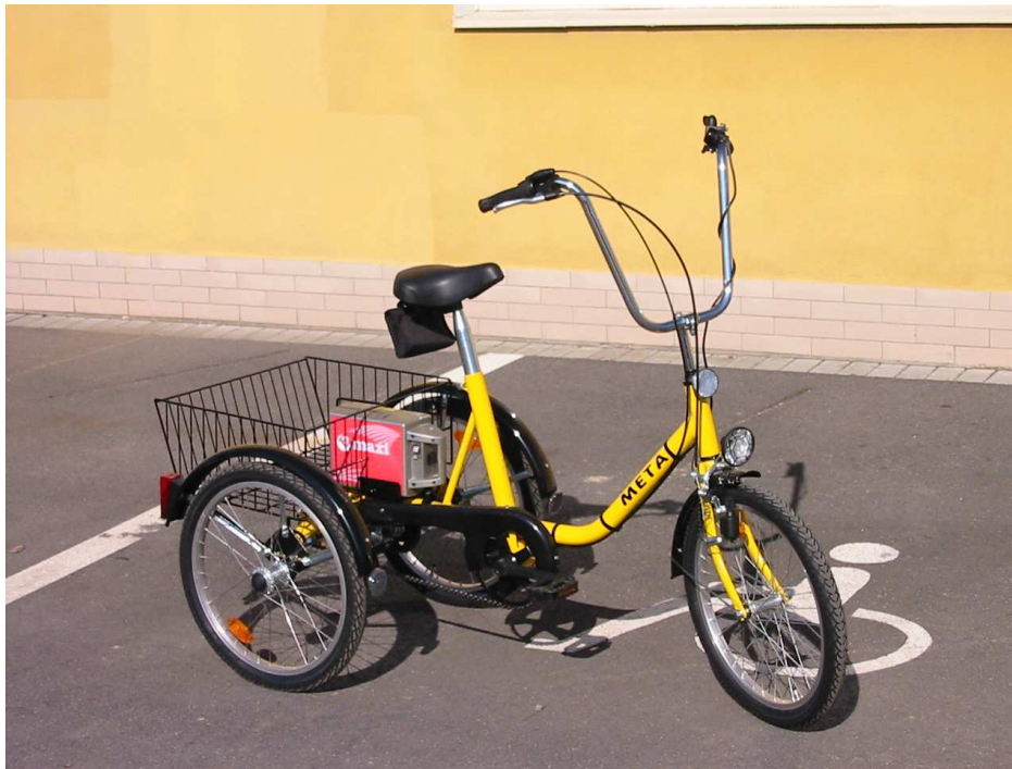
Obr. 5.3: Praktická ukázka zapojení elektromotoru v zadní části vozidla [7]
