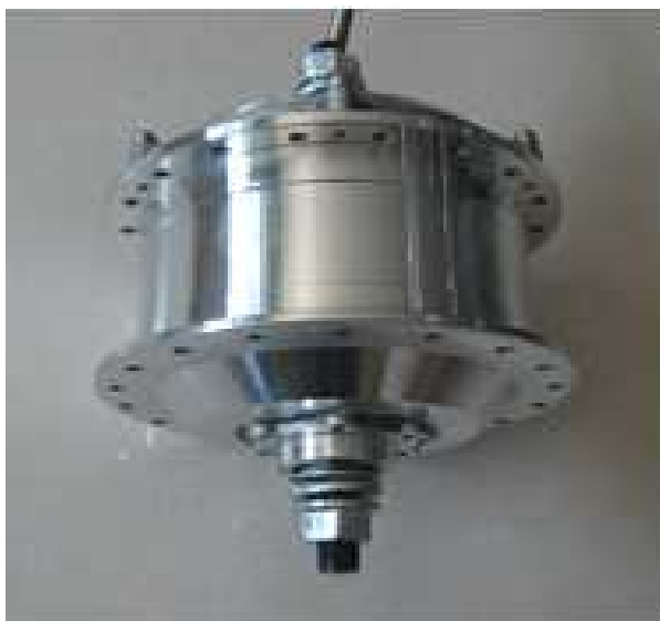
Obr. 5.2: Hub motor s planetovou převodovkou [6]
