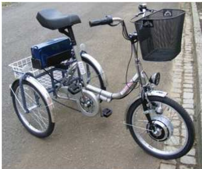
Obr. 2.2: Elektromotor umístěn v náboji předního kola – tzv. Hub motor [1]
