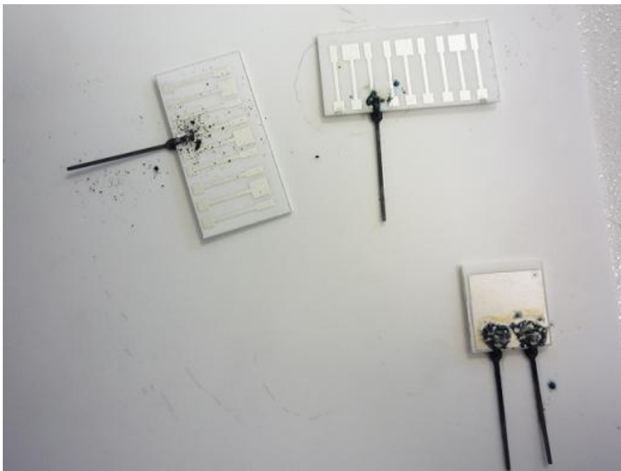
obr. 30 Substráty po vytažení z pece při hodinovém cyklu
