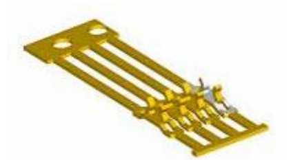
obr. 7 Hřebínkové vývody DIL [5]
