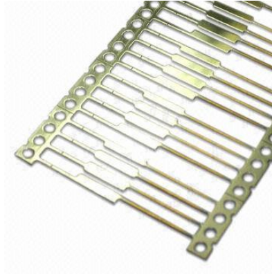
obr. 10 Hřebíkové vývody se zlatými kontakty [7]
