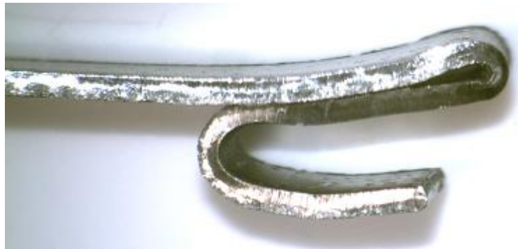
obr. 17 Tvar vývodu ze slitiny železa, niklu a chromu
