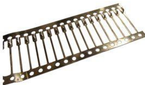
obr. 6 Hřebíkové vývody SIL [6]
