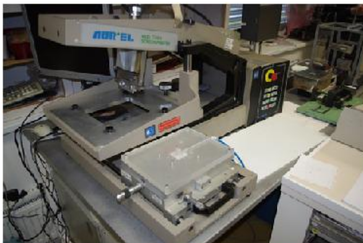
obr. 18 Síťotiskový poloautomat AUREL C 880 Screen Printer
