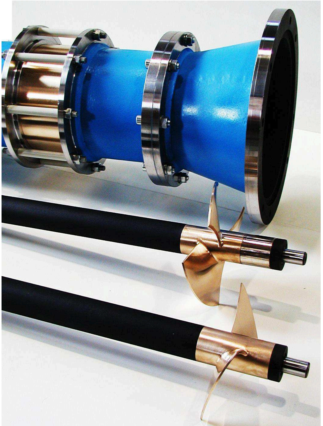
Obr. 7.4 Vyrobené komponenty pro vírovou turbínu s protiběžnými koly. Výroba byla provedena dle výkresové dokumentace uvedené níže. Fotodokumentaci uvedenou na obrázcích 7.2; 7.3; 7.4 prováděli pracovníci odboru FLI VUT.
