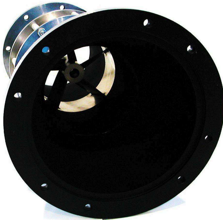
Obr. 7.2; 7.3 Vyrobené komponenty pro vírovou turbínu s protiběžnými koly. Výroba byla provedena dle výkresové dokumentace uvedené níže Fotodokumentaci uvedenou na obrázcích 7.2; 7.3; 7.4 prováděli pracovníci odboru FLI VUT .
