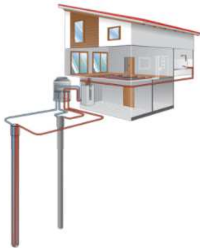
Obr. 9 TČ země/voda hlubinný vrt [6]
