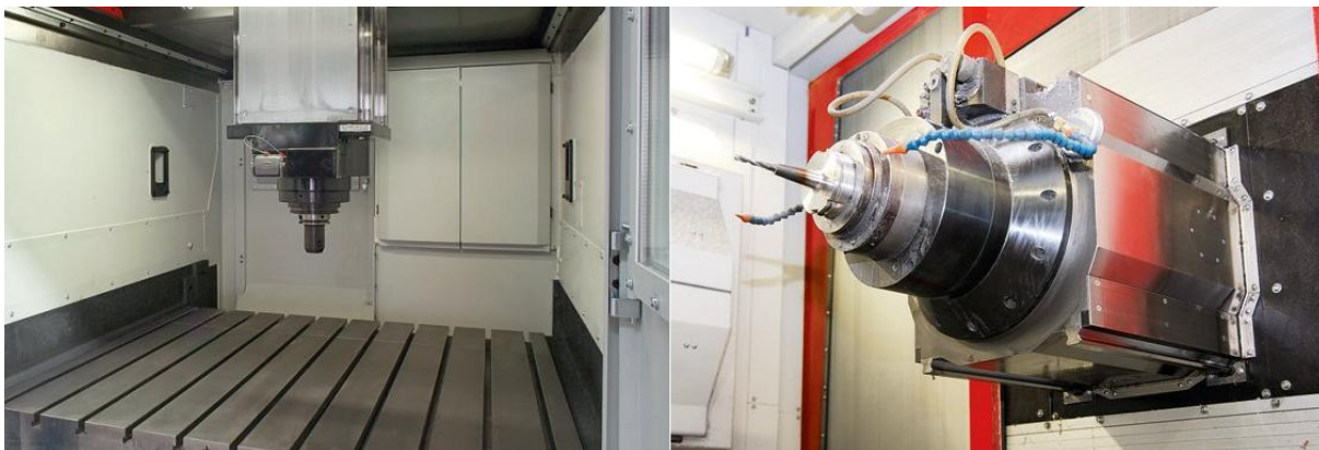
Obrázek č. 2.1 - Vertikální a horizontální vřeteno [5]
