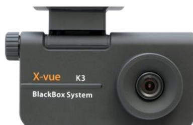
Obr. 1 – Video záznamová jednotka – černá skříňka [5].
