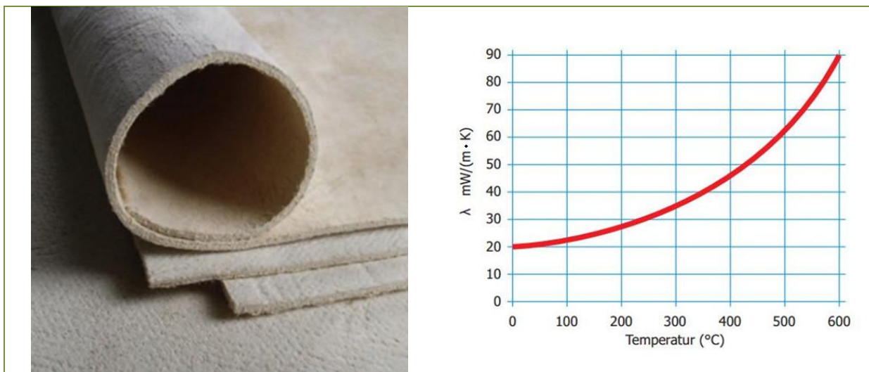
Obrázek 4.13 Izolace Pyrogel XT a závislost tepelné vodivosti na zvyšující se teplotě[11]
