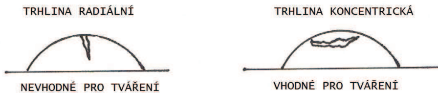
Obr. 3.6 Určení materiálu dle tvaru trhliny
