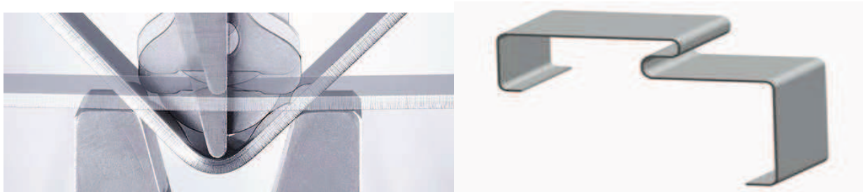
Obr. 2.4 Příklad ohybu plechu a výsledné součásti [18]
