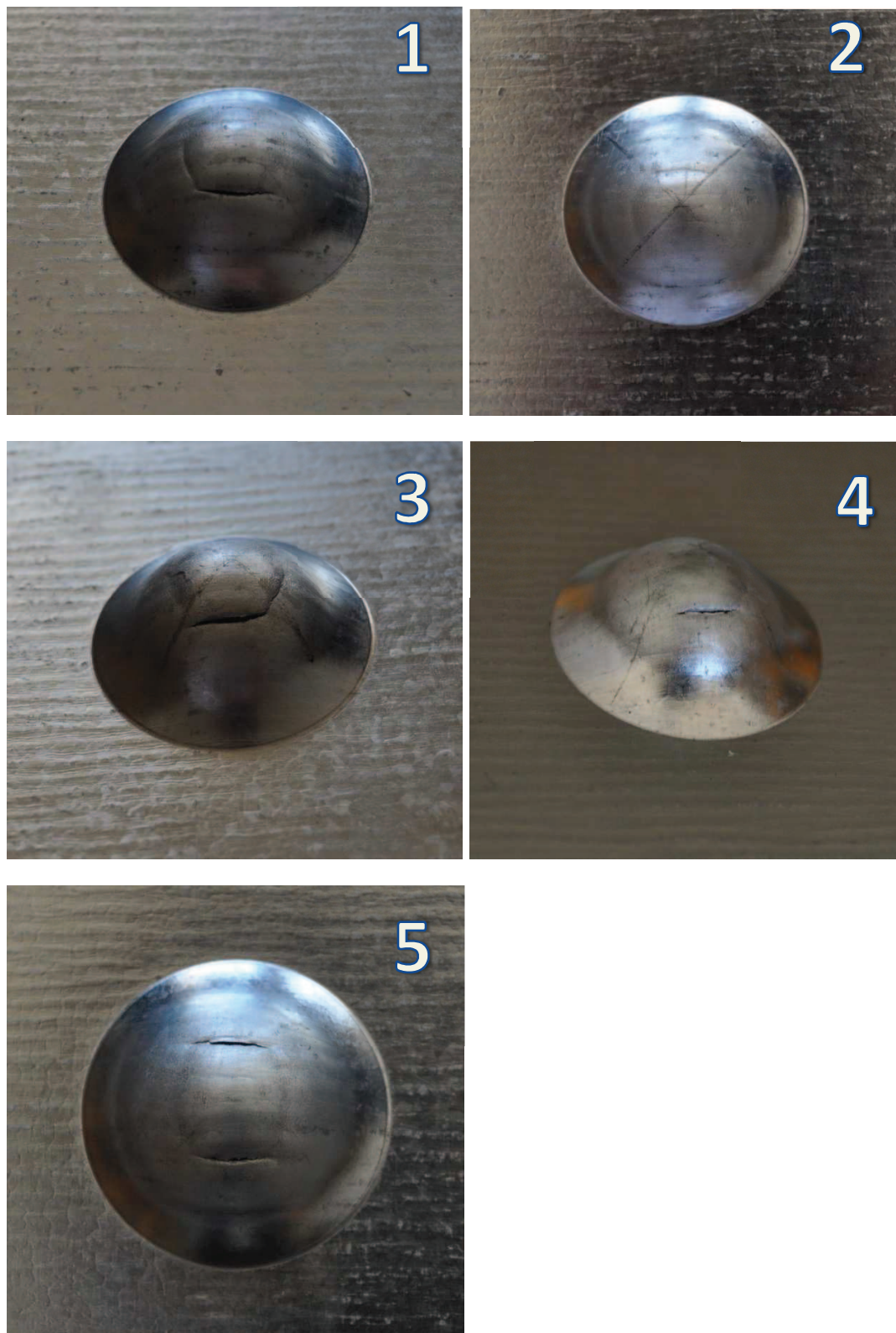
Obr 4.3 Zkušební vzorky Erichsenovy zkoušky
