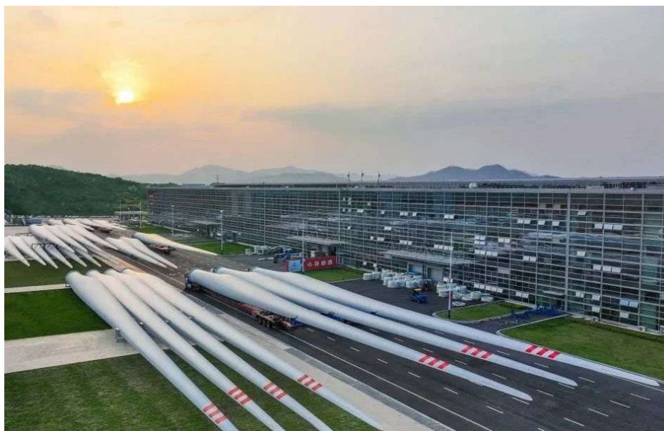
Obr. 4.3: Nejdelší lopatka onshore VTE na světě s délkou 131 m [25].
