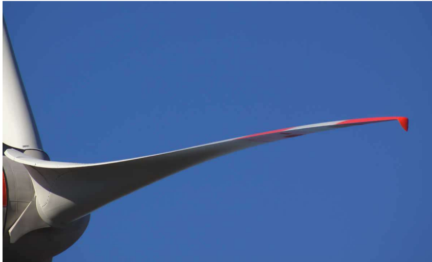
Obr. 7.6: Aplikace wingletu na lopatce rotoru větrné elektrárny [100].
