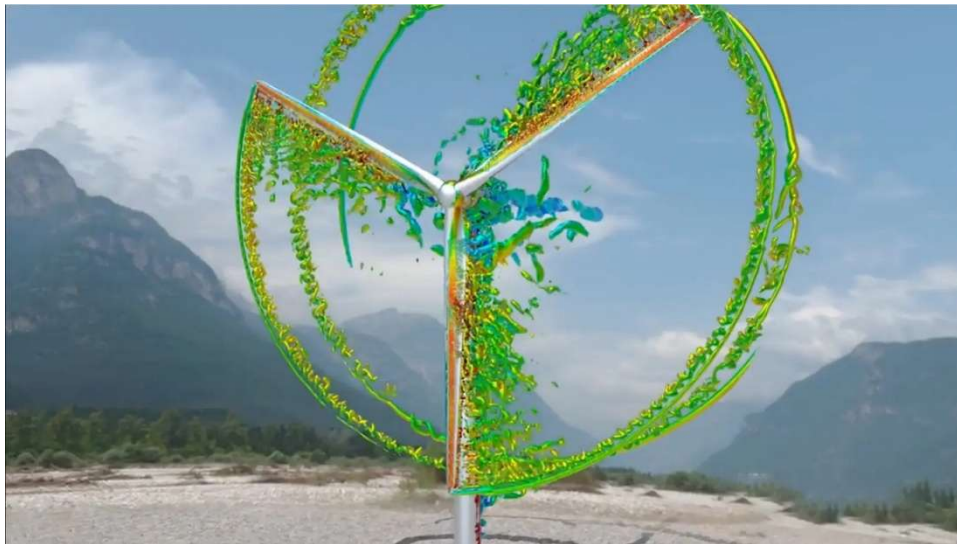
Obr. 5.13: Vizualizace proudění větru kolem lopatek větrné turbíny pomocí CFD simulace [97].
