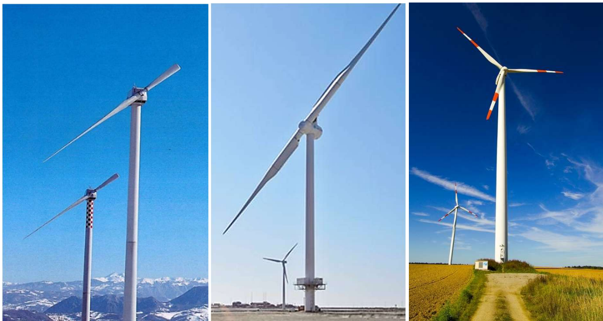
Obr. 3.8: Horizontální VTE s 1 lopatkou [92].
