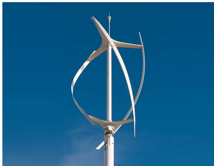
Obr. 3.11: Darrieova turbína s nakloněnými listy rotoru do spirály zabraňujícími nepříjemným pulzacím [21].
