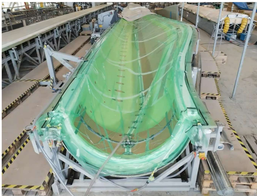
Obr. 8.4: Infuze pryskyřice metodou VARTM [86].
