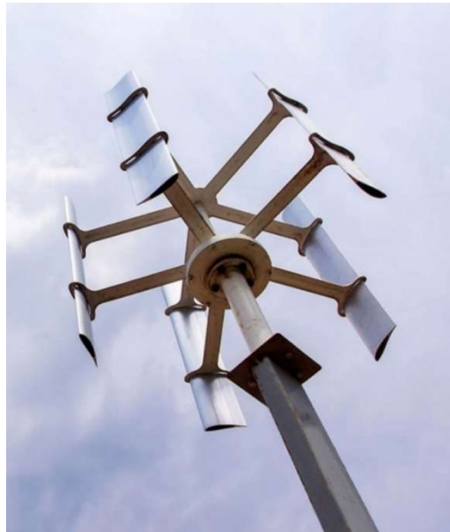
Obr. 3.10: Darrieova turbína s lopatkami ve tvaru H [21].
