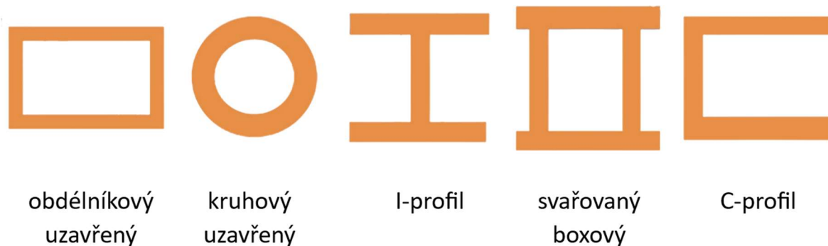
Obr. 7.1: Geometrické tvary používaných profilů lopatek větrných turbín ([69], upraveno autorem).
