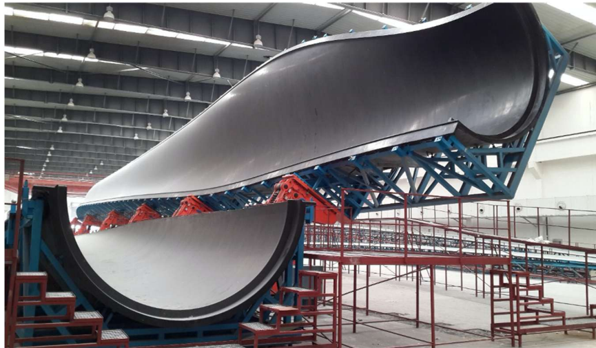
Obr. 8.1: Systém hydraulických závěsů forem pro výrobu lopatek větrných turbín [89].
