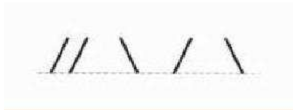
Obr. 9.6 Uspořádání ložisek na vřetenu [2]
