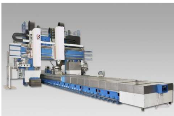
Obr. 1.4 Portálová frézka s posuvným stolem [7]
