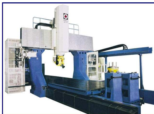
Obr. 2.3 Portálová frézka typu horní (vlevo) a spodní (vpravo) gantry [5,6]
