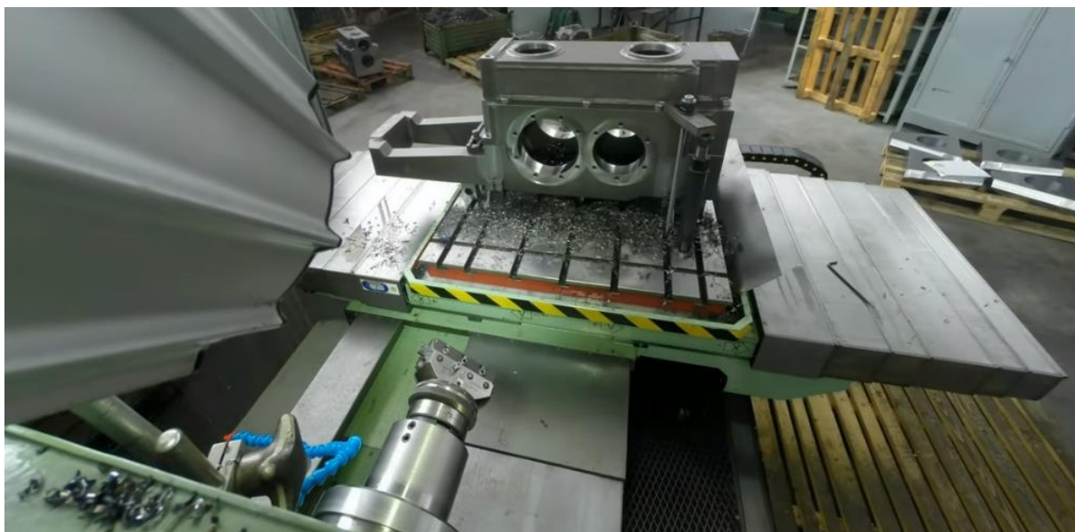
Obr. 34) Vyvrtávání na stroji WH 10 CNC, TOS Varnsdorf [38]
