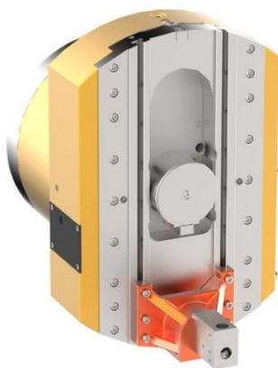
Obr. 31) Lící deska LD650 výrobce TOS Varnsdorf [22]
