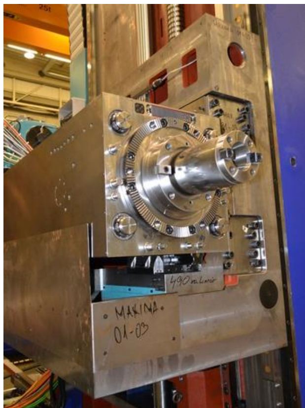
Obr. 11) Vřeteník smýkadlového typu s výsuvným pracovním (vyvrtávacím) vřetenem, stroj MAXIMA výrobce TOS Varnsdorf [22]
