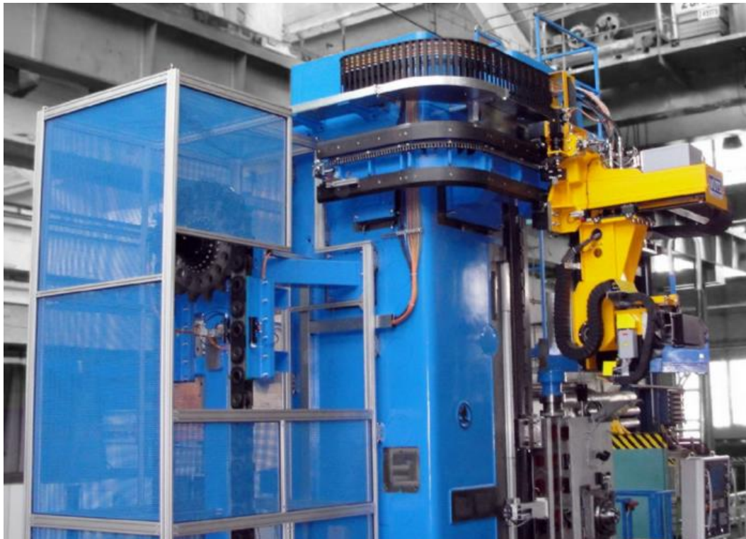
Obr. 32) Manipulátor ATC 6/150 pro vodorovná obráběcí centra, VÚTS Liberec [34]
