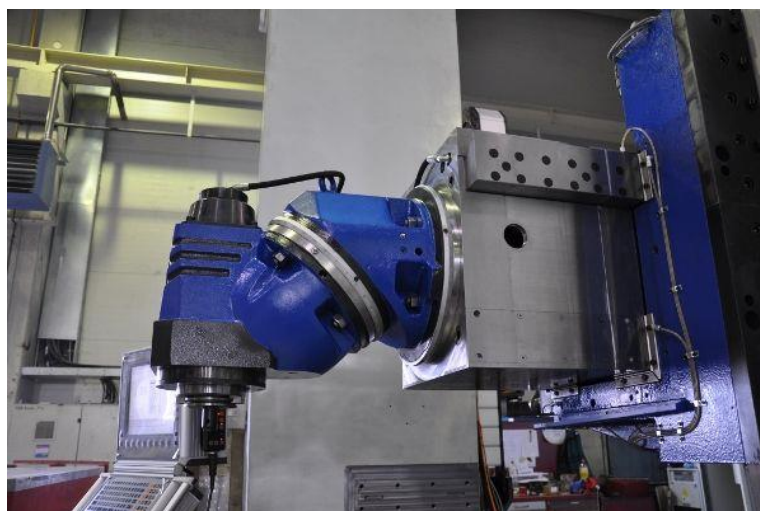
Obr. 30) Univerzální automatická frézovací hlava výrobce Fermat Machinery [33]
