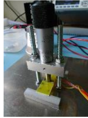
Obr. 40: Detailný záber na DPS a mikrometrický šroub pri meraní
