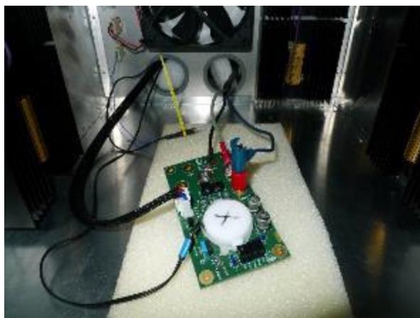
Obr. A.6: Zapojený modul referencie LTZ1000(A) pri meraní výstupu 7V BUF
