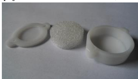
Obr. 62 Kryt referencie LTZ1000(A) zabraňujúci prúdeniu vzduchu okolo púzdra a vývodov
