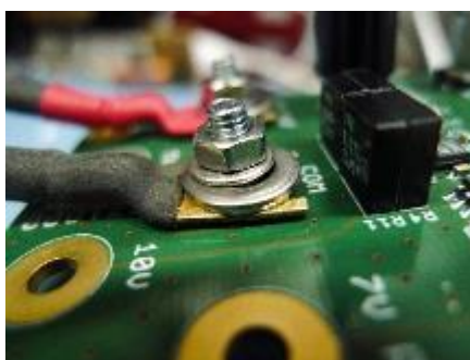
Obr. A.5: Záber na reálne pripojenie meracieho kábla k výstupu modulu
