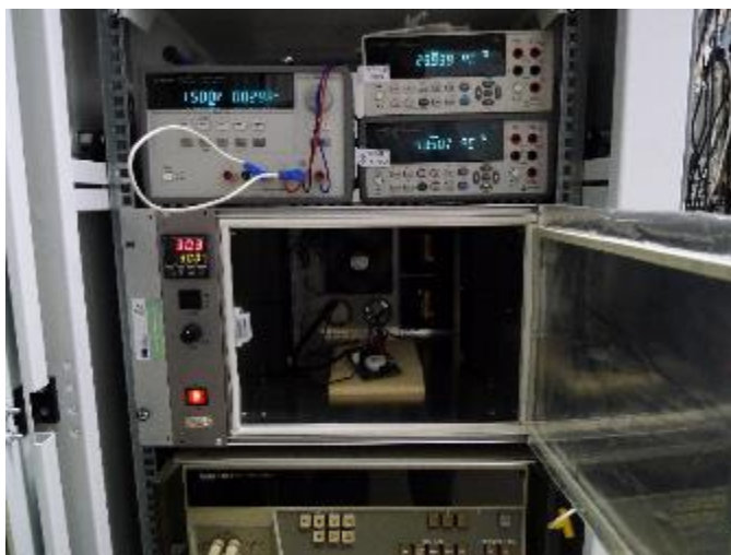
Obr. A.1: Teplotná komora spolu s napájacím zdrojom modulu a prístrojmi na meranie teploty v komore a na puzdre LTZ1000(A)
