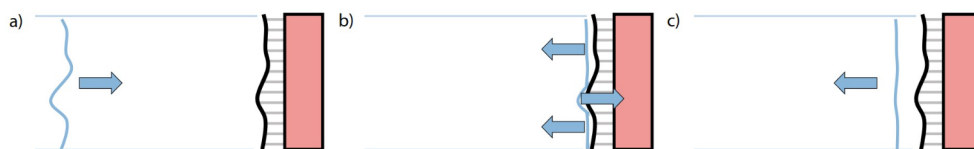
Obr. 2.2: Nákres korekce vlnoplochy pomocí deformovatelného zrcadla (a) Vlna s poškozenou vlnoplochou dopadá na deformovatelné zrcadlo. b) Odraz vlny od povrchu zrcadla a předání profilu do optické fáze vlny. c) Odražená vlna s upravenou fází [12])
