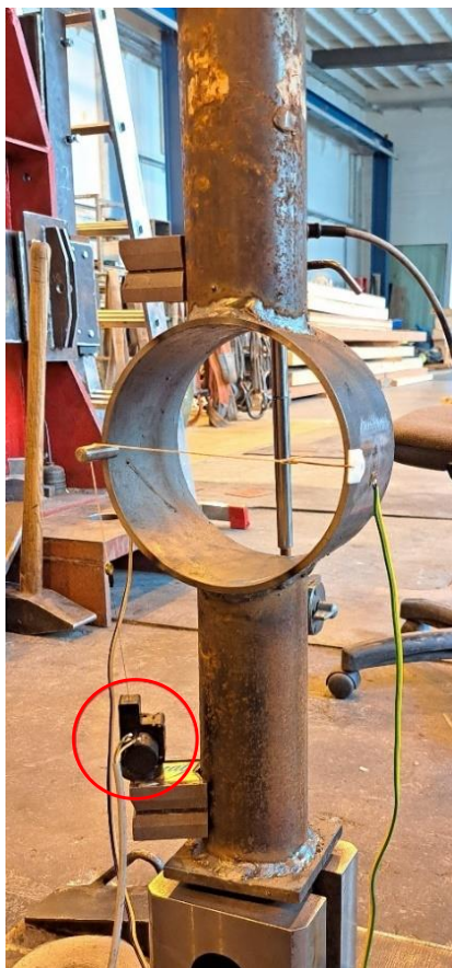
Obr. 2.05: Umístění potenciometrického snímače polohy
