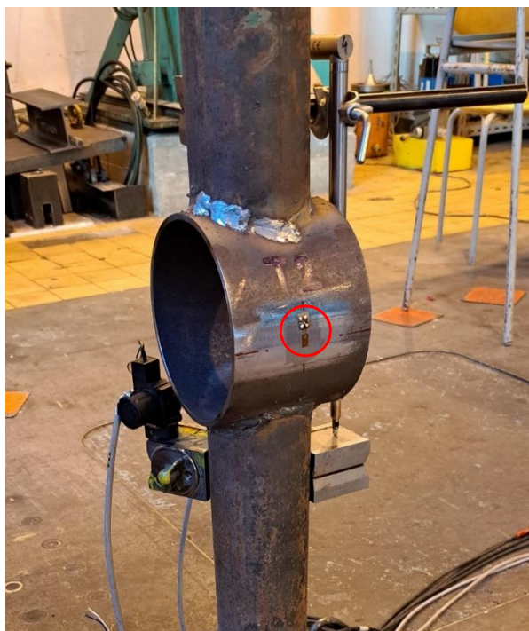
Obr. 2.04: Umístění tenzometrů na prstenci
