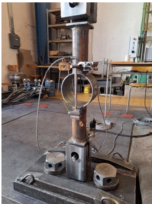
Obr. 2.08: Těleso T4 – osazené měřicími přístroji (vlevo), deformované po provedení zkoušky (vpravo)
