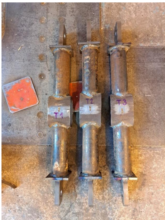
Obr. 2.09: Tělesa T1-T3 po zkoušce- boční pohled (vlevo) a pohled zepředu (vpravo)
