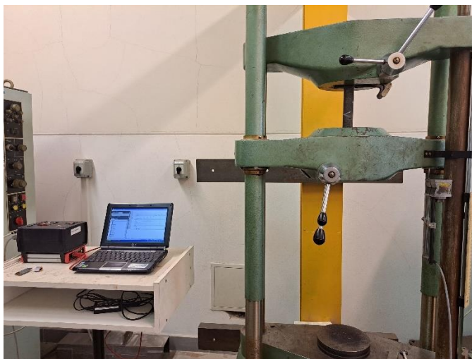
Obr. 2.17: Trhací stroj (vpravo) s přístrojem pro zaznamenávání průběhu zkoušky (vlevo)
