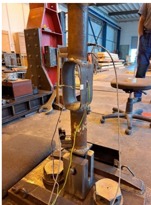
Obr. 2.08: Těleso T4 – osazené měřicími přístroji (vlevo), deformované po provedení zkoušky (vpravo)
