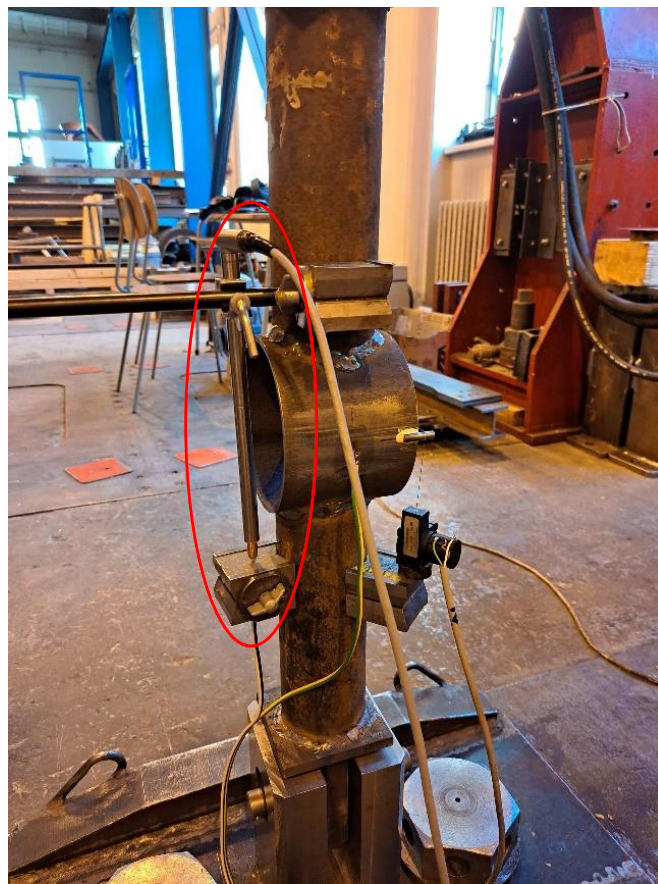
Obr. 2.06: Umístění indukčního snímače polohy
