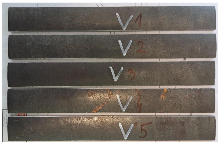
Obr. 2.12: Vzorky V – TRKR 133×4,5 mm
