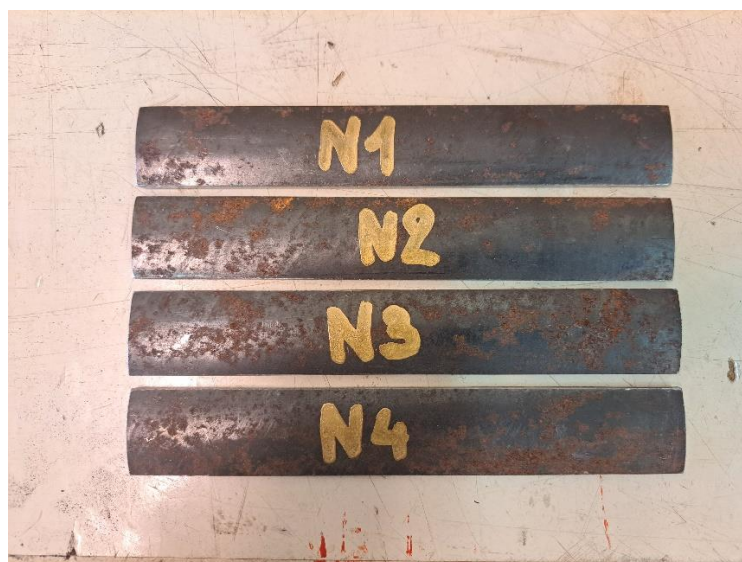
Obr. 2.13: Vzorky N – TRKR 76,5×3,5 mm
