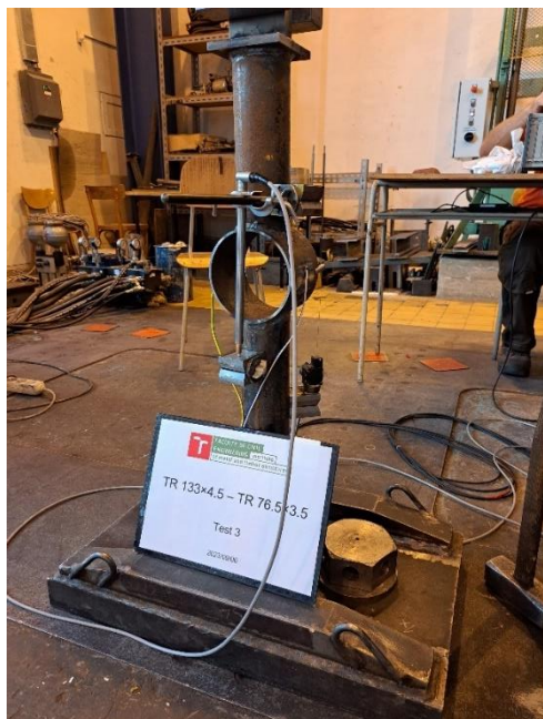
Obr. 2.07: Těleso T3 – osazené měřicími přístroji (vlevo), deformované po provedení zkoušky (vpravo)
