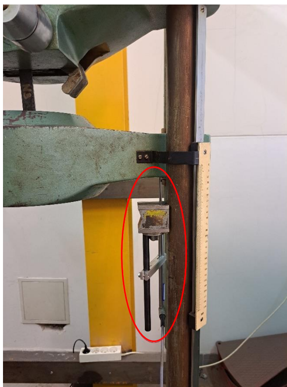
Obr. 2.14: Umístění indukčního snímače polohy
