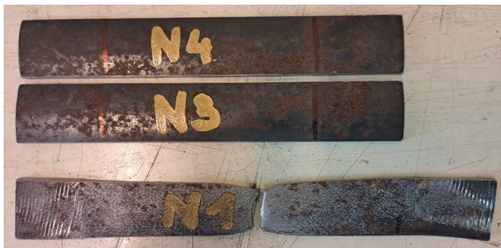
Obr. 2.15: Vzorky N – porovnání těles před zkouškou a po zkoušce
