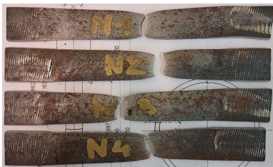
Obr. 2.16: Vzorky N – po zkoušce
