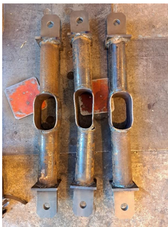
Obr. 2.09: Tělesa T1-T3 po zkoušce- boční pohled (vlevo) a pohled zepředu (vpravo)
