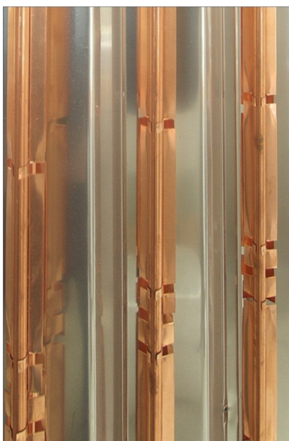
Obr. 2.5 Detail Cu křidélek zvětšujících teplosměnnou plochu
