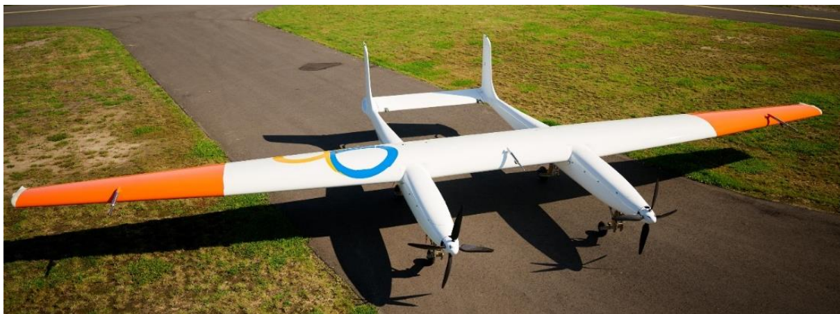
Obr. 4.7 Větrný drak nizozemské společnosti OrangeAerospace AMPYX Power AP3 [41].
