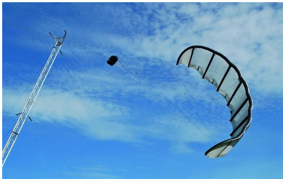
Obr. 3.2 Hybridní křídlo LEI C-draka vyvinutého na TU Delft [41].
