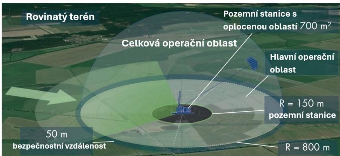
Obr. 2.1 3D vizualizace provozní oblasti systému AWE. V tomto případě je R délka lana (800 m) a je zohledněna bezpečnostní vzdálenost 50 m ([1], upraveno).
