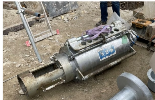
Obr. 2-10 Hydraulický lis Tensa 4800 kN, foto: autor
