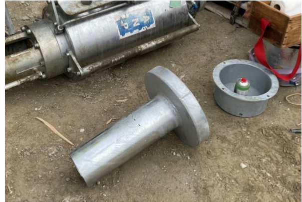
Obr. 2-3 Průchodová trubice s kotevní deskou a víko, foto: autor
