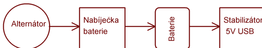
Obr. 1 Blokové schéma jednoduché nabíječky
