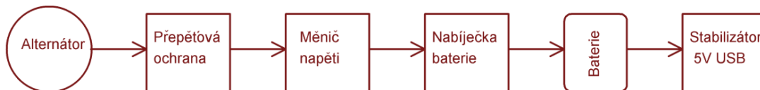
Obr. 3 Blokové schéma nabíječky s vstupním měničem
