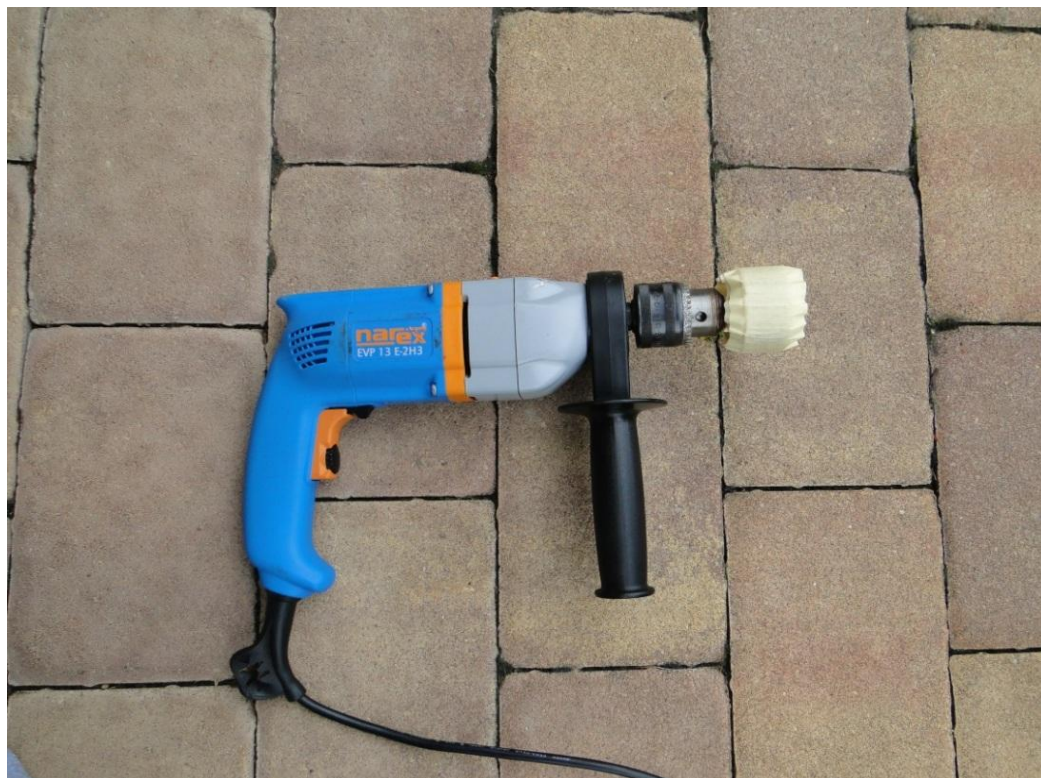
Obr. 44 Vrtačka s násadou pro pohon předního kola
