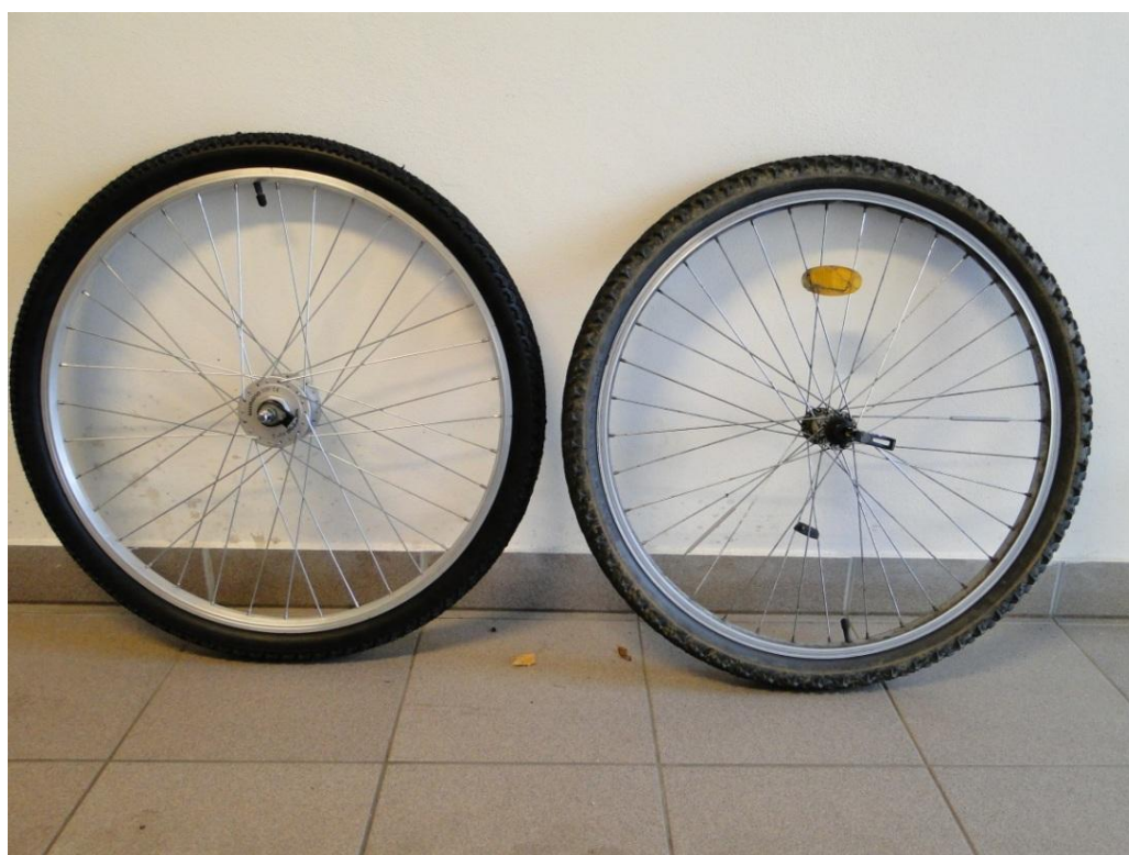
Obr. 42 Porovnání normálního středu a moderního dynama
