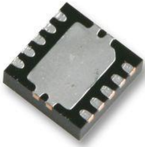
Obr. 20 Pouzdro obvodu MCP73123 (převzato z [12]).
