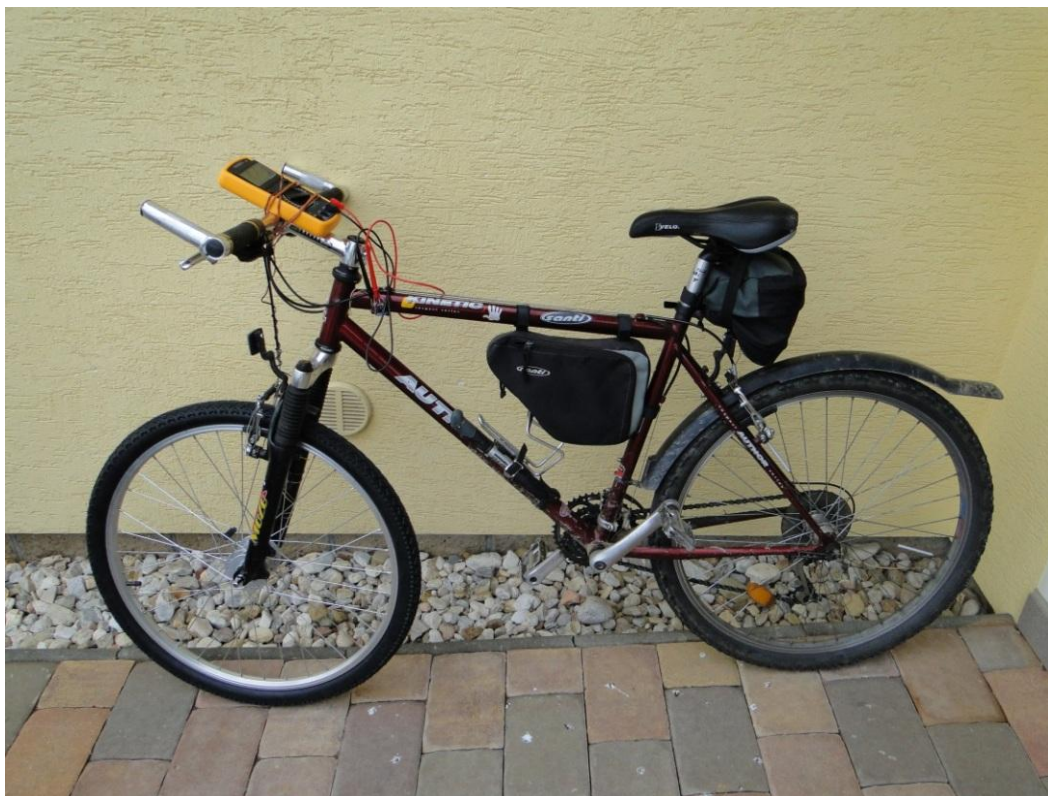
Obr. 43 Kolo s měřícím přístrojem připraveno na rychlostní zkoušku
