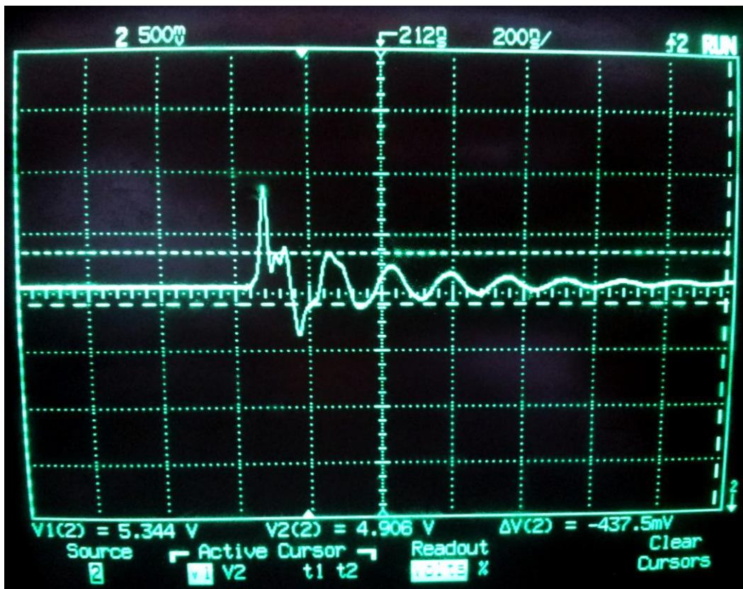
Obr. 56 Průběh zvlnění napětí na výstupu externího měniče
