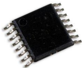
Obr. 13 Pouzdro obvodu LM5116 (převzato z [9]).
