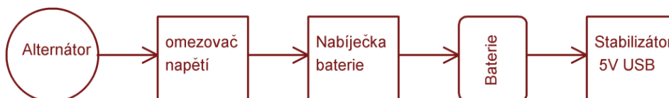
Obr. 2 Blokové schéma nabíječky s omezovačem
