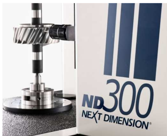
Obr. 8.27: Měření ozubeného kola pomocí systému Sicmat ND300 [17]
