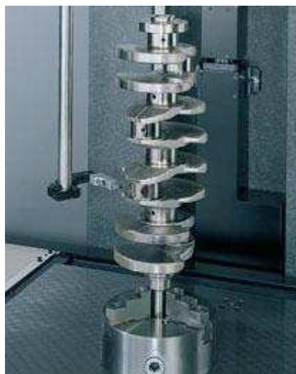
Obr. 8.21: Měření klikové hřídele pomocí přístroje Rondcom 75 [12]
