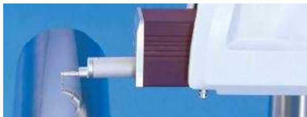
Obr. 8.10: Měření struktury povrchu válcové plochy [11]
