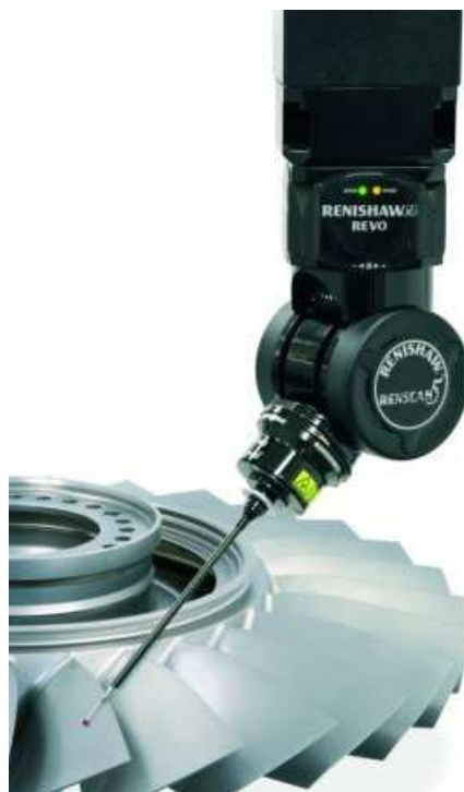
Obr. 8.41: Pětiosé skenování pomocí Renishaw REVO [10]
