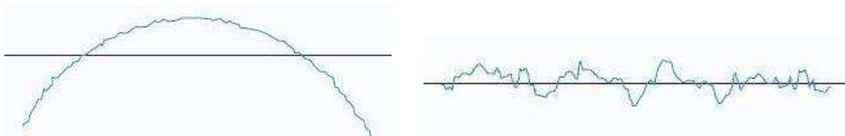
Obr. 8.11: Princip R-kompence povrchu válcové plochy [11]
