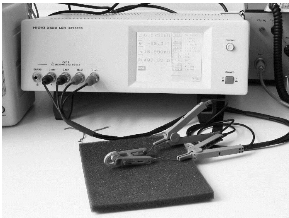
Obrázek 4-9 Vlastní zapojení pro měření impedanční charakteristiky pomocí RLC metru HIOKI 3532 a svorek HIOKI 9140
