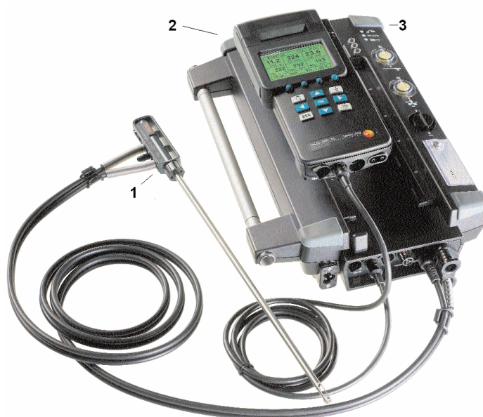
Obr. 9 Schéma přístroje Testo 350M/XL; 1 – odběrová sonda, 2 – kontrolní jednotka s odnímatelnou tiskárnou a displejem, 3 – analyzátor spalin s integrovanými měřicími senzory.
