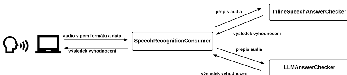
Obrázek 6.2: Diagram znázorňující komunikaci mezi moduly během vyhodnocování výsledků zadaných hlasem. Během odpovědi uživatele je zvukový záznam odeslán klientem na server, kde dochází k jeho přepisu. Na základě typu příkladu je následně vybrána příslušná třída pro vyhodnocení přepisu a výsledek je odeslán zpět klientovi.
