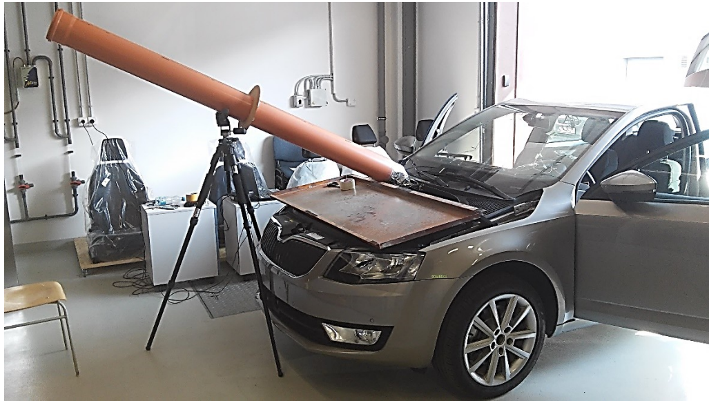
Obr. 29 Ustalovací kanál instalován na automobilu
