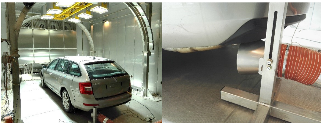
Obr. 44 Automobil v klimatické komoře a detail na odsávání spalin
