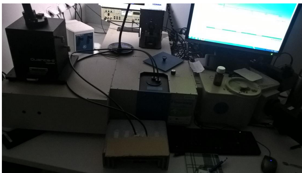
Obrázek 40: Fluorimetr Fluorolog používán pro měření fluorescence sond z prostředí hydrogelů, využíváno bylo nástavce s optickými kabely
