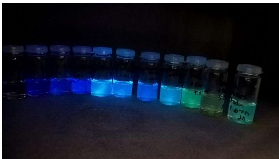
Obrázek 44: Fluorescenční sonda Prodan v prostředích různé polarity, osvětlena pod UV lampou; různě barevná fluorescence způsobena solvatochromním efektem
