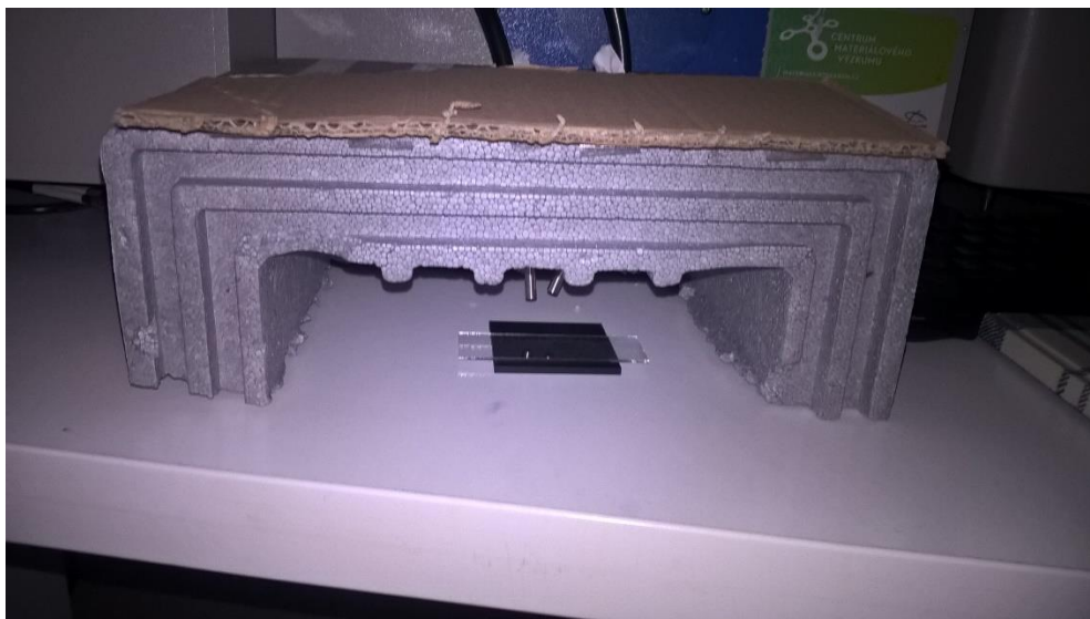
Obrázek 41: Uspořádání pro měření fluorescence sond z prostředí hydrogelů, do nástavce sloužícího pro odstínění okolního světla jsou přivedeny optické kabely, z nichž jeden přivádí excitační záření a pomocí druhého je snímána emise fluoroforu; vzorek hydrogelu je nanesen na krycí sklíčko, položen na obdélník z plastu neodrážející záření a vložen pod optické kabely
