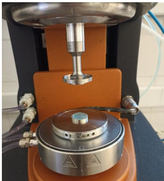
Obr. 1: Ukázka měření amplitudových testů na reometru s geometrií deska–deska
