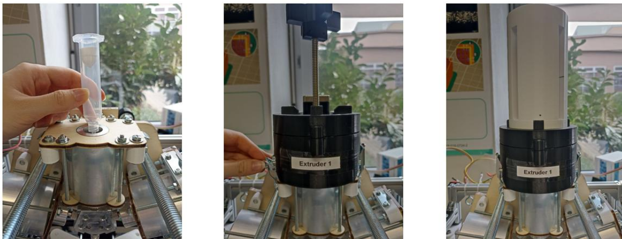
Obr. 8: Zásobník se nejprve vloží do tiskové komory (vlevo). Poté se nasadí extrudér povolený na minimum a následně se postupně přitahuje tak, aby došlo ke kontaktu šnekového mechanismu s pístem (uprostřed). Nakonec je systém zajištěn pomocí stabilizační objímky (vpravo).
