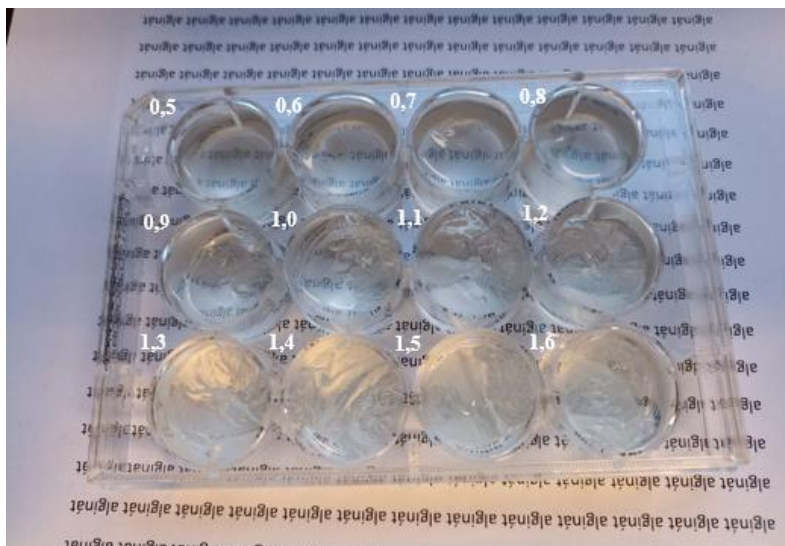
Obr. 13: Mikrotitrační destička se vzorky alginátu s různým přidavkem sířovicího činidla
