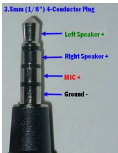
Obrázek 7: Headset connector [11]
