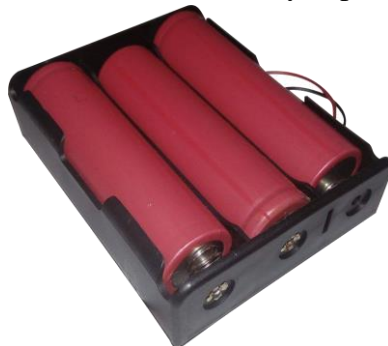
Obrázok 5.3: Sériové zapojenie troch batérii Sanyo 18 650 v púzdre
