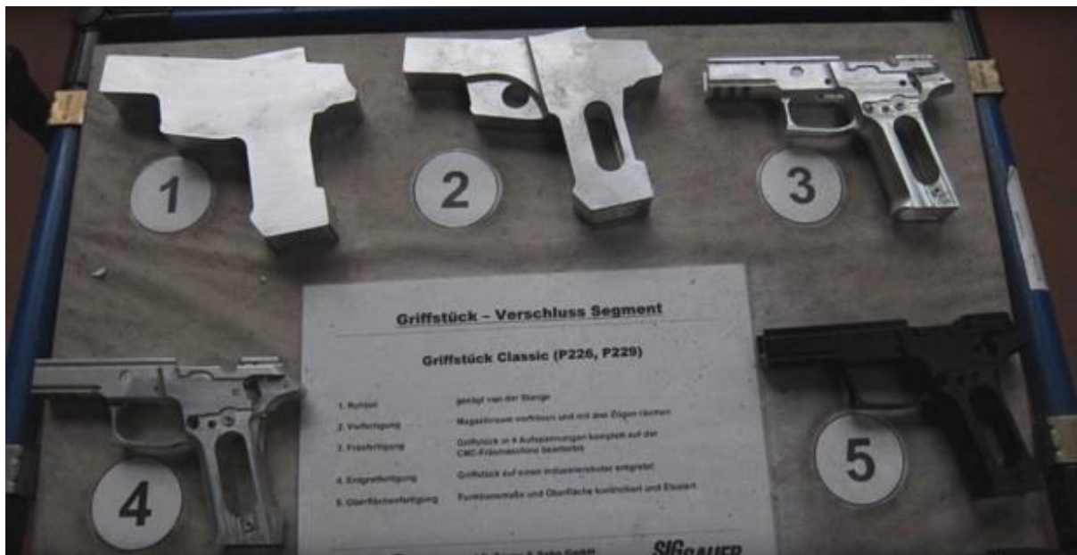
Obr. 5.4 Ukázka fází výroby frézovaného rámu ve firmě Sig Sauer [28].
