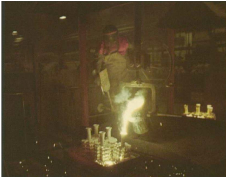
Obr. 3.3 Stromeček z obr. 3.2 během lití [8].
