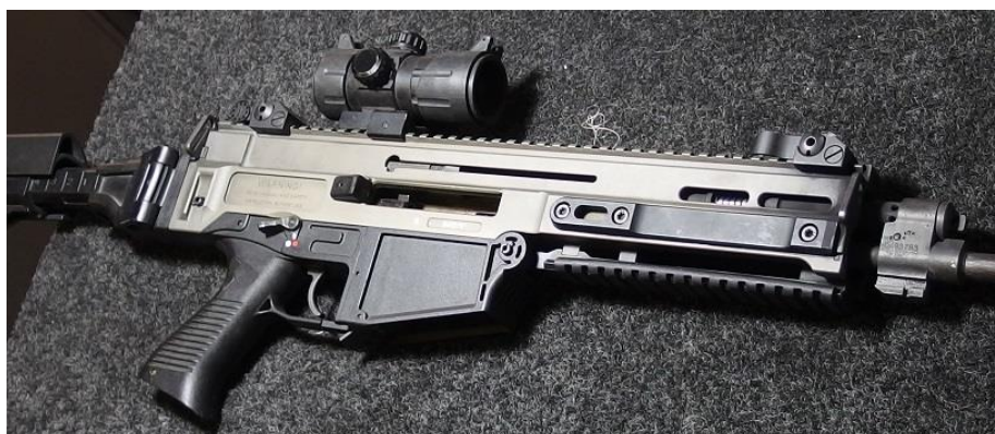
Obr. 2.11 Samonabíjecí verze pušky CZUB 805 Bren osazená kolimátorem, jejíž samočinnou varianta nahrazuje v AČR starší pušky vz. 58 [5].
