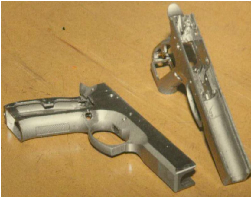
Je patrné, že v přední části stále zbývá dokončit lištu pro příslušenství Obr. 3.5 Lité rámy Pistole SP-01 po třískovém obrábění [8].
