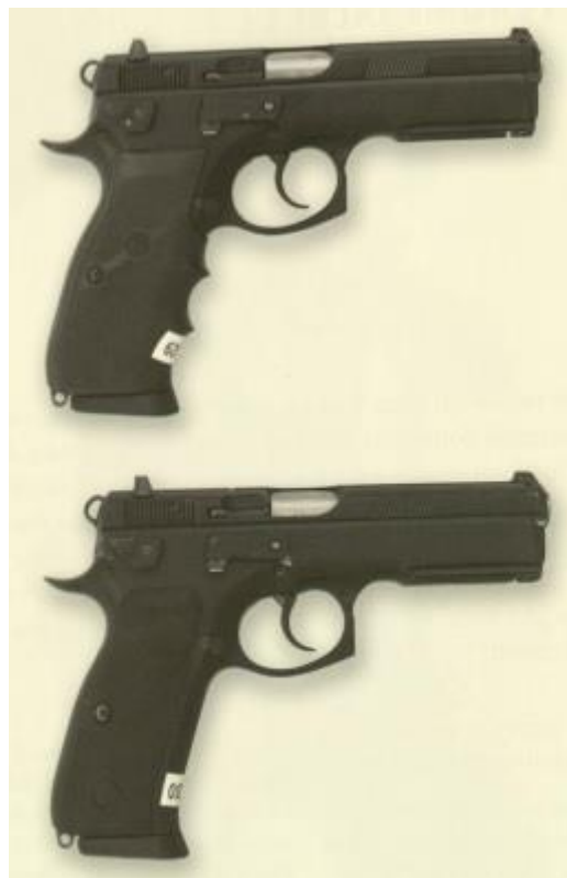
Obr. 3.11 Prototypy pistole SP-01 vyrobené pouze třískovým obráběním [8].
