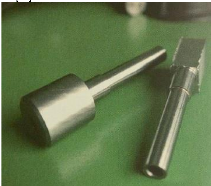
Obr. 4.18 Vykovaná hlaveň po soustružení (vlevo) a frézování (vpravo) před dokončením [8].
