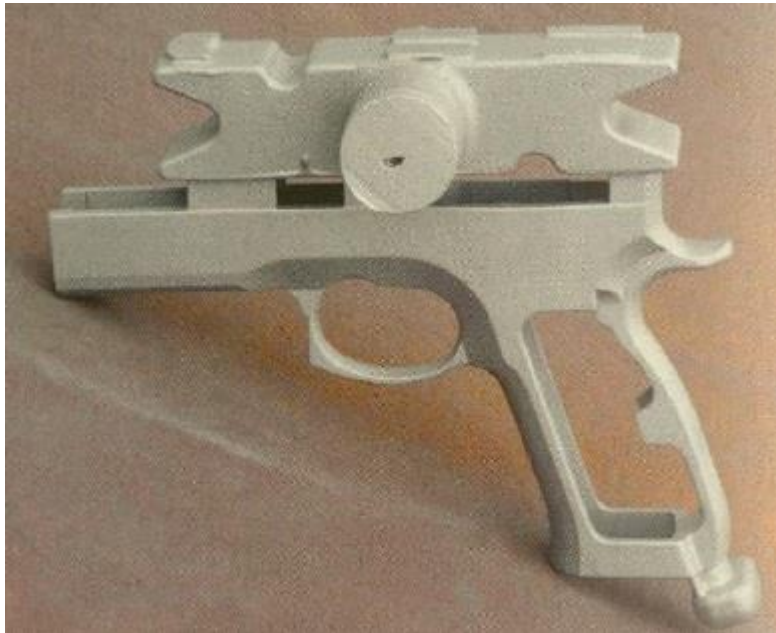
Obr. 3.4 Odlitek rámu SP01 oddělený od stromečku, avšak stále přítomnými vtoky [8].
