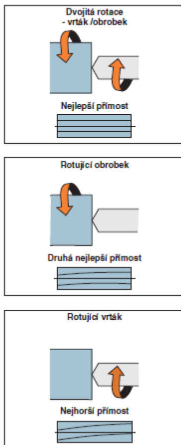
Obr. 4.6 Vliv kinematiky procesu na přímost díry [16].
