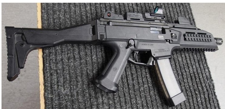
Za povšimnutí stojí fakt, že pouzdro závěru je vyrobeno z polymeru. Obr. 2.8 Civilní verze moderního českého samopalu CZUB Škorpión EVO 3 [5].
