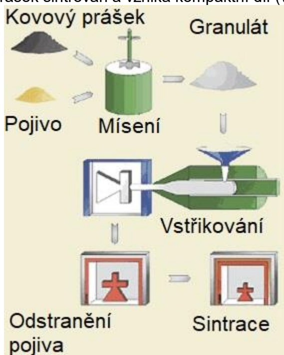
Obr. 3.12 Schéma procesu MIM [12].
