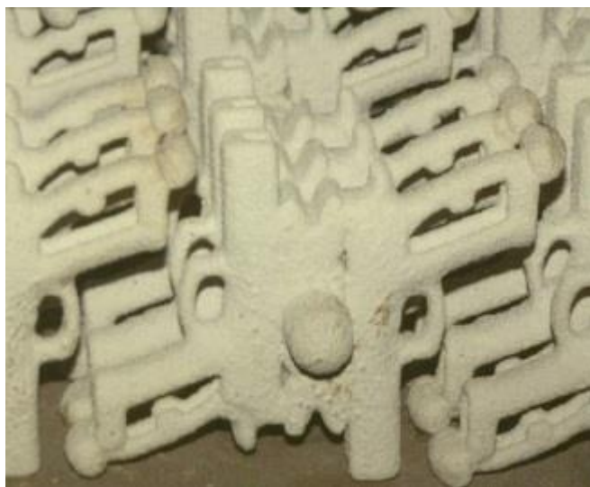
Obr. 3.2 Stromeček z obr. 3.1 po obalování [8].
