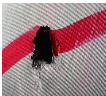
Obr. 5-6 Vada řešeného odlitku – staženina/vzdušná perezita
