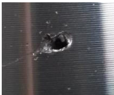
Obr. 5-4 Vada řešeného odlitku – vzdušná perezita
