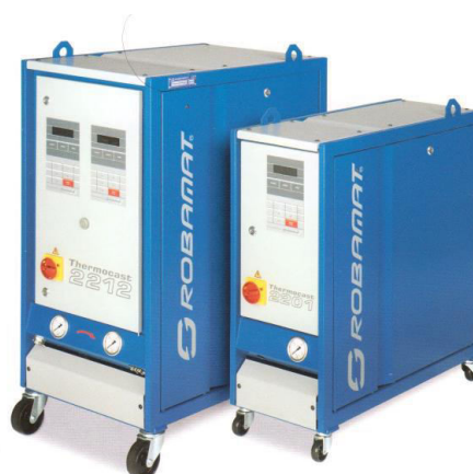
Obr. 2-18 Temperační zařízení ROBATMAT [10]
