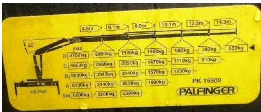
Obrázek 4 Pracovní schéma ramena nákladního auta, Zdroj [65]
