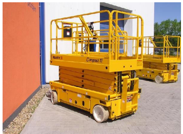
Obr. 7.13: Nůžková plošina Compact 12 (zdroj: [22])
