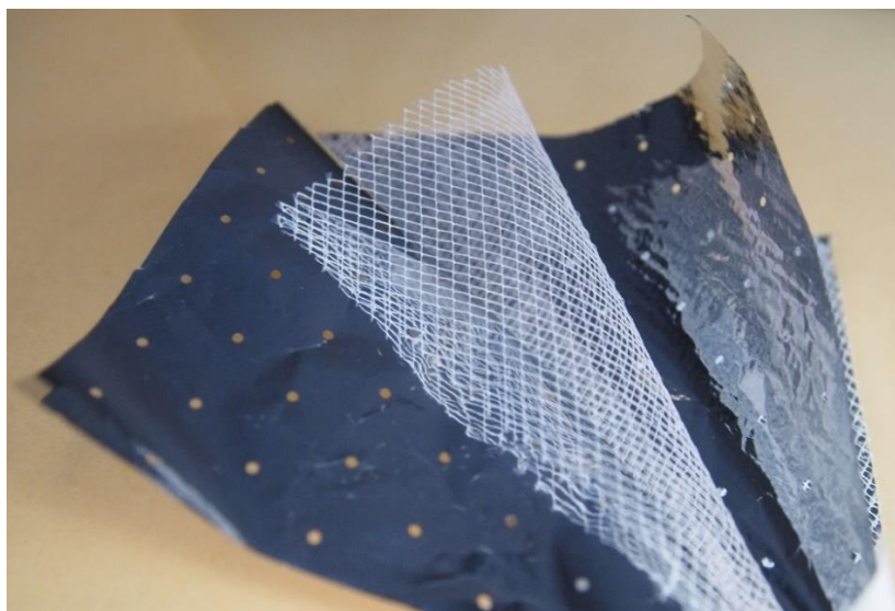
Obrázek 4.3 Snímek jednotlivých vrstev MLI (separační mezivrstva a perforované hliníkové fólie). Převzato z [18]
