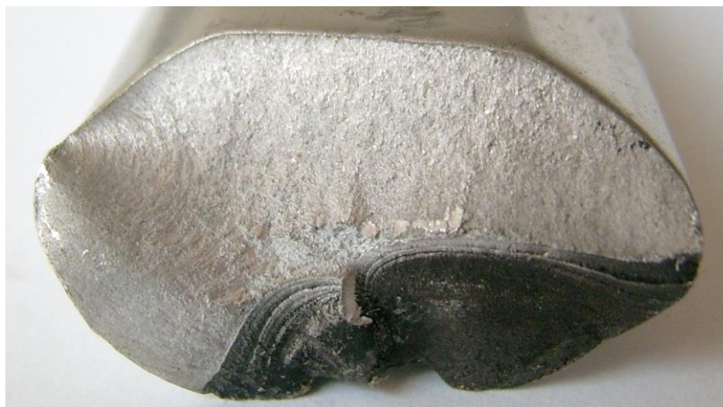
Obrázek 5.2 Snímek praskliny hliníkového konstrukčního prvku. Tmavá oblast – rozpraskání únavou. Světla oblast – rychlé zlomení. Převzato z [25]
