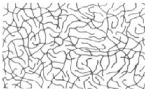
Obr. 2.2 Struktura amorfního termoplastu [5]
