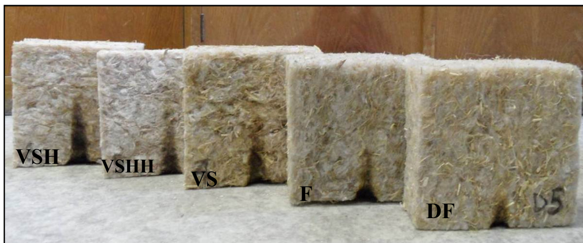
Obr. 37 Vzorky po zkoušce malým plamenem, zleva: vzorek ošetřený vodním sklem s HCl, vzorek ošetřený vodním sklem s HCl a silanem HDTMS, vzorek ošetřený vodním sklem, vzorek ošetřený hydrogenfosforečnanem diamonným a vzorek ošetřený dihydrogenfosforečnem amonným
