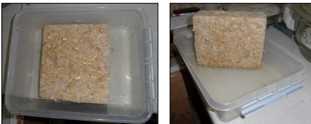
Obr. 21 Namáčení vzorku bylo provedeno ze všech stran vzorku
