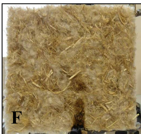
Obr. 34 Vzorek ošetřený hydrogenfosforečnanem diamonným po zkoušce malým plamenem
