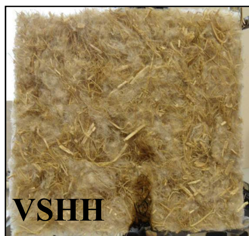
Obr. 32 Vzorek ošetřený vodním sklem s HCl a silanem HDTMS po zkoušce malým plamenem
