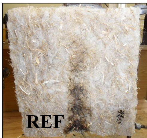
Obr. 27 Referenční vzorek bez ošetření po zkoušce malým plamenem
