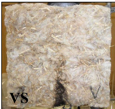
Obr. 33 Vzorek ošetřený vodním sklem po zkoušce malým plamenem
