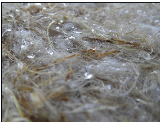
Obr. 39 Kapičky vody na povrchu vzorku ošetřeným prostředkem Tagal po zkoušce krátkodobé nasákavosti
