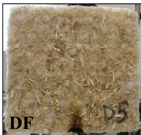
Obr. 35 Vzorek ošetřený dihydrogenfosforečnanem amonným po zkoušce malým plamenem
