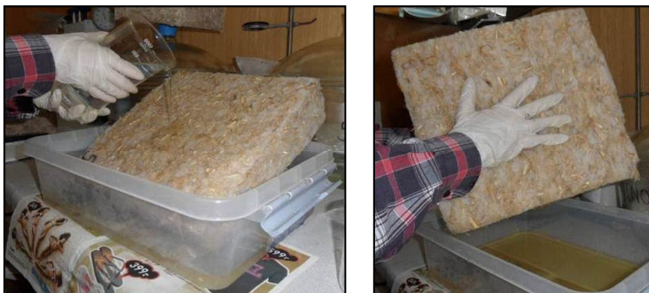
Obr. 22 Nalítí roztoku na vzorek, pro dokonalejší prosycení vzorku a odstranění přebytečného roztoku
