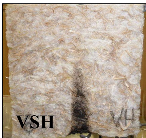
Obr. 31 Vzorek ošetřený vodním sklem s HCl po zkoušce malým plamenem
