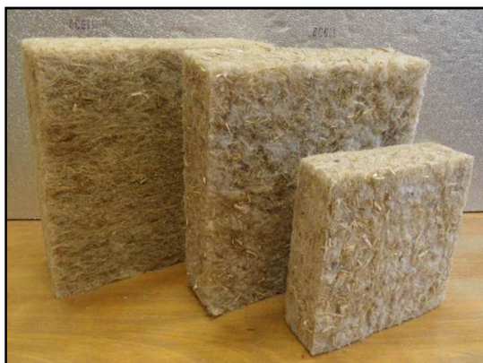
Obr. 19 Konopné desky pro experimentální účely, zleva: konopná rohož firmy Canabest, konopné rohože z laboratoří Ústavu technologie stavebních hmot a dílců
