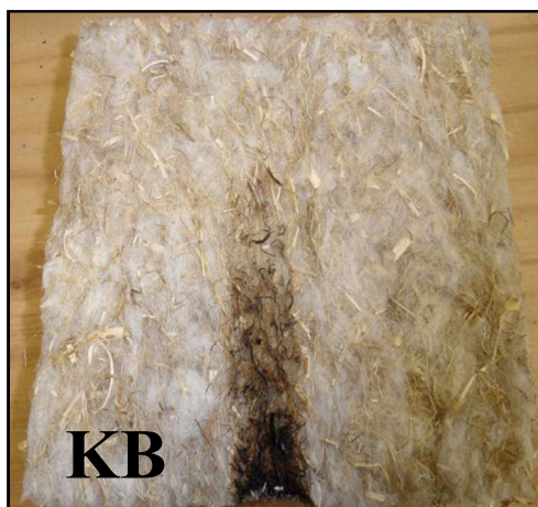
Obr. 29 Vzorek ošetření kyselinou boritou po zkoušce malým plamenem
