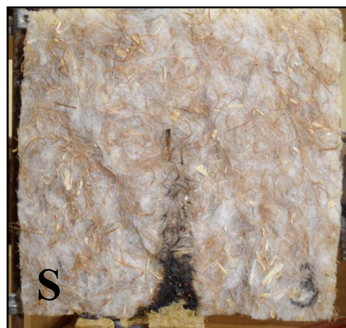
Obr. 30 Vzorek ošetřený sodou po zkoušce malým plamenem
