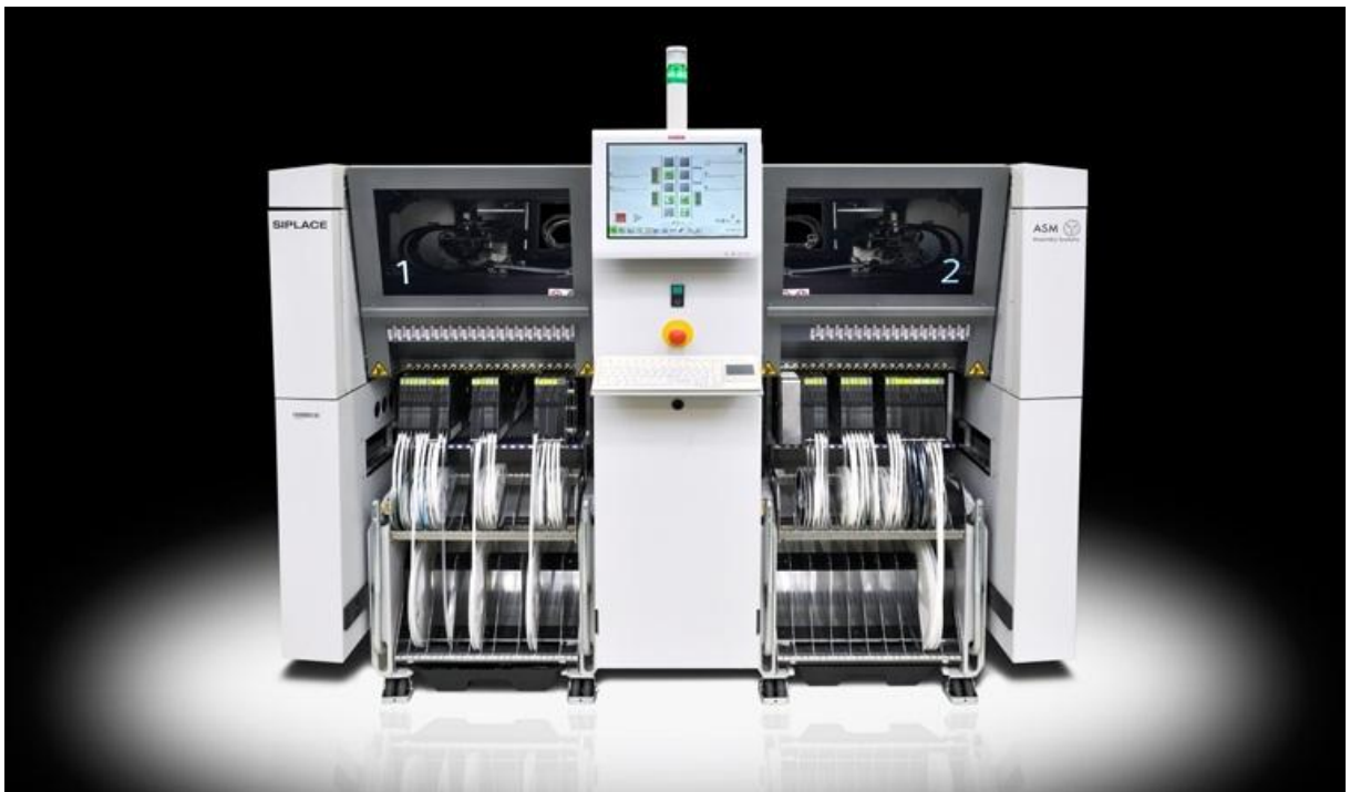
Obrázek 14 – SMT osazovací stroj se zasunutými stoly s podavači
