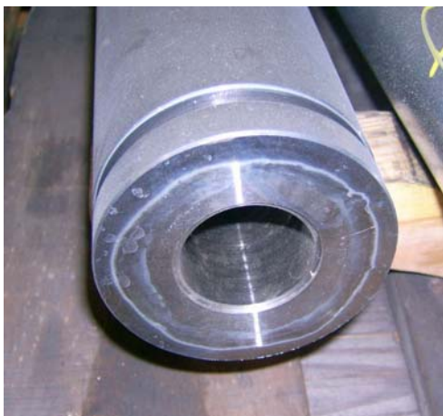
Obr. 5.7 Kus před navařením zátky
