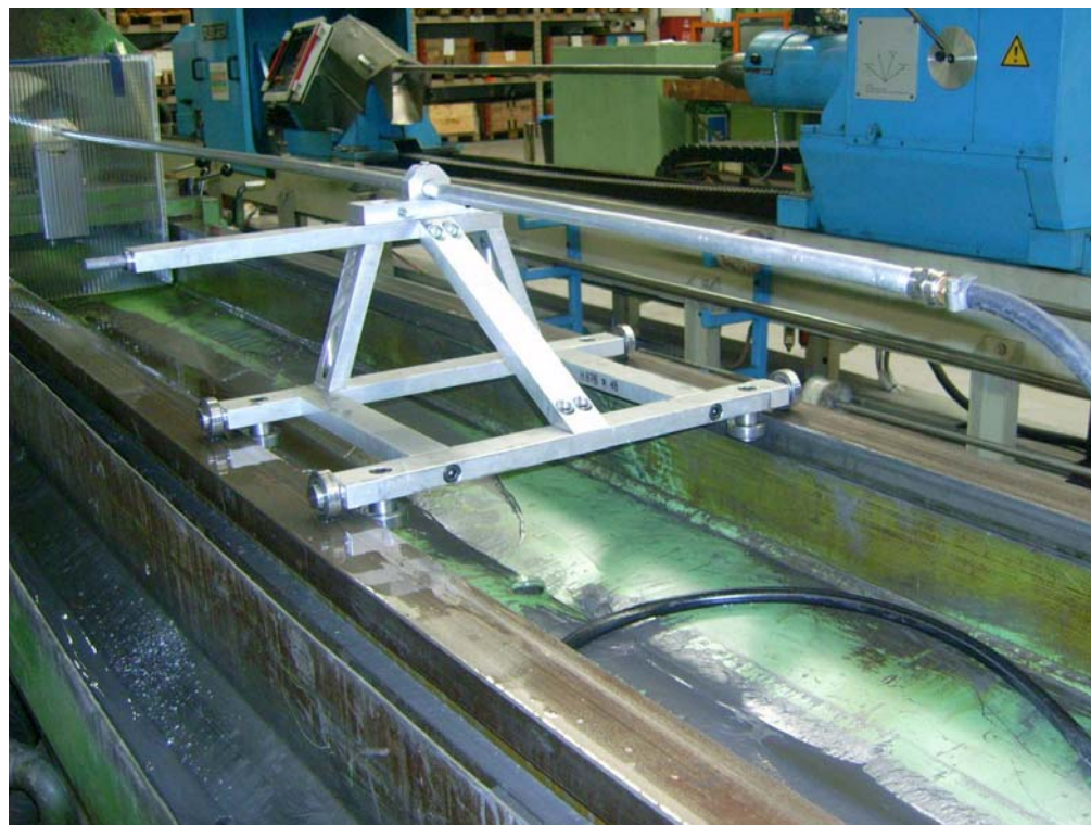
Obr. 7.4 Pohyblivá konstrukce z duralu
