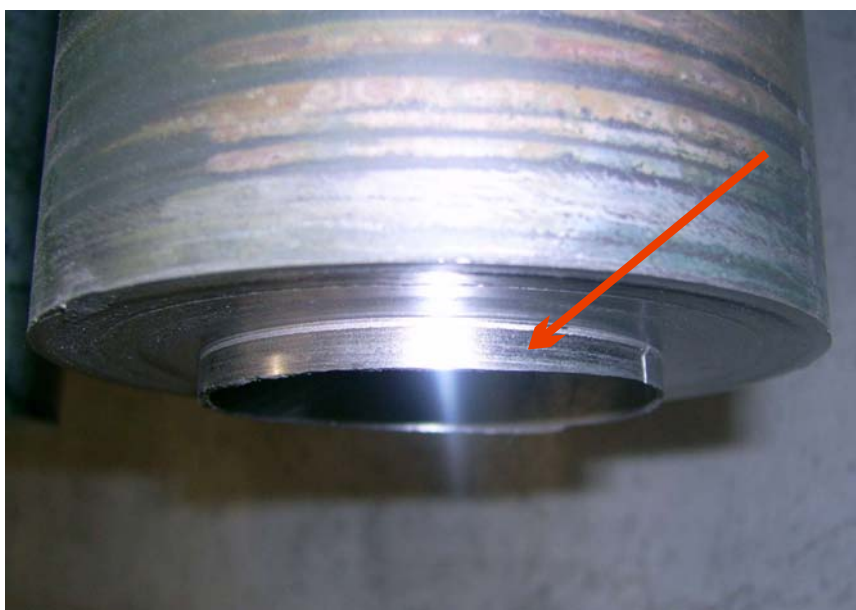
Obr. 7.13 Vyčnívající část uraženého naneseného kovu
