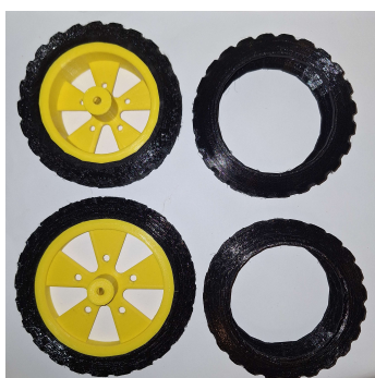
Obr. 3.3: Kolesá rôznej veľkosti a hustoty výplne testované pre model vozidla
