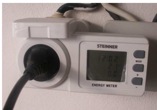
obr. 20 - Odečet reálné spotřeby elektrické energie na přístroji Steiner enm 100
