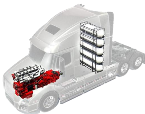
Obr. 10 Integrace vodíkového spalovacího motoru a tlakových nádrží v kamionu [32]
