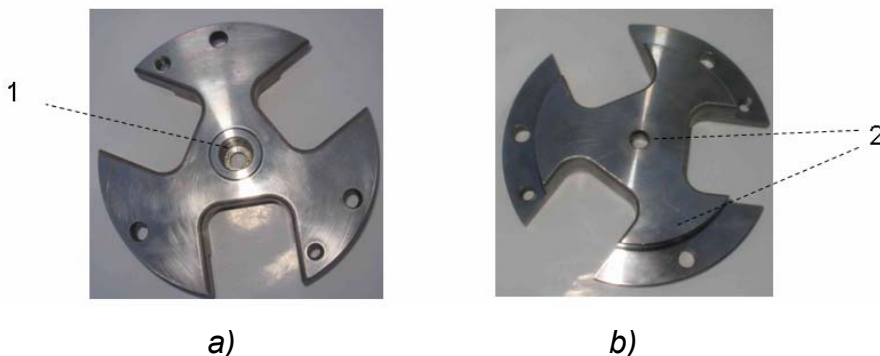
Obr.2.3 Obráběná součástka MEZIKUS s průměrem \varnothing 16\ H7 a), souosostí osazení o \varnothing 104\ h6 b).
