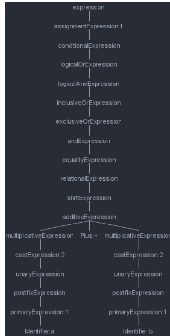
Obr. 7.1: Ukážka derivačného stromu, vygenerovaného z výrazu ‘ a + b ’
